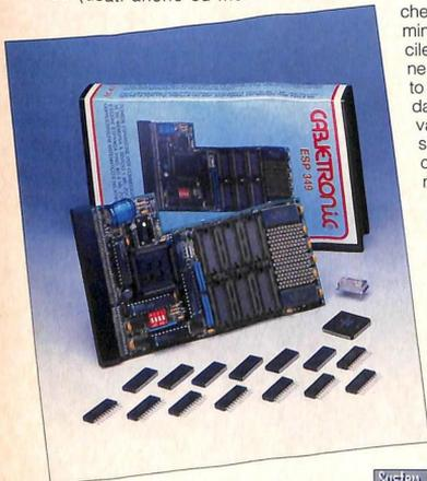
schede grafiche e analoghi ai PLCC) e per i successivi 4 Mb chip di tipo ZIP. La scheda può montare anche un coprocessore matematico. E ovviamente presenta l'orologio con batteria tampone ricaricabile.
