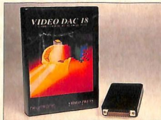
DAC 18. Scheda grafica per A500/600/2000/3000. Permette di lavorare e visualizzare 262.000 colori come su Amiga 1200/4000. Completamente trasparente, grazie alla porta RGB passante, può funzionare in cascata con genlock e digitalizatori.
