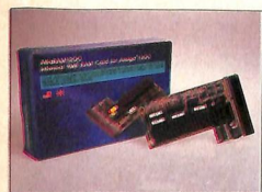
ALFARAM: espansione da 1Mb per A-1200 espandibile a 9 Mb di fast ram. Zoccolo per coprocessore e clock.
