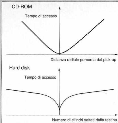
*Grafici del tempo di posizionamento della testina in funzione dello spostamento radiale in un lettore di CD-ROM e in un hard disk voice-coil che non usa la tecnica "zone recording".
