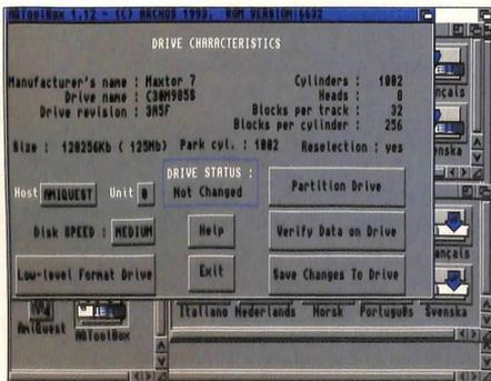
AQToolBox corrisponde al programma HDToolbox del Workbench e permette di modificare le partizioni, di formattare a basso livello l'hard disk, di verificare i blocchi su disco, di cambiare altri parametri come il filesystem utilizzato e così via.
