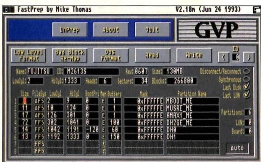
*Lo stesso hard disk di figura 2 visto da Faastprep. Poiché l'RDB è standard, non ci sono incompatibilità. Tutto è concentrato in un'unica schermata; la voce "Disconnect/Reconnect" equivale a "Supports reselection" su HDtoolbox. Le voci "last Disk" e "last Lun" saranno spiegate sui prossimi numeri di Amiga Magazine.*
