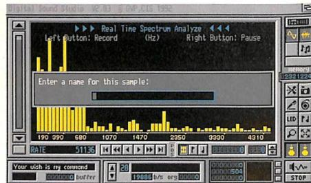
**Abbiamo terminato la digitalizzazione: DSS ci chiede un nome per il campione. Sullo sfondo l'analizzatore di spettro.**
