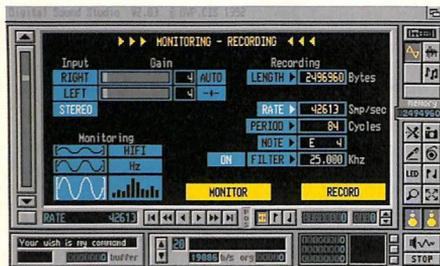
**Il pannello per impostare i parametri di digitalizzazione. Si noti la frequenza: 42613 campioni al secondo in stereo.**
