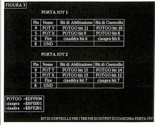
In particolare, tre pin per ogni porta Joy possono essere (a scelta dell'utente) configurati via software come output, uno indipendentemente dall'altro. Sono il pin 9, il pin 5 e il pin 6.
