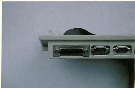
Ecco come appare il connettore esterno: si presenta rovesciato per evitare confusioni con altre vaschette DB presenti sul retro del 1200.
