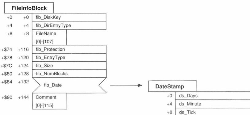
Figura 1: La struttura FileInfoBlock
