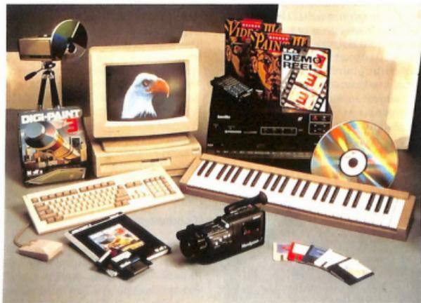
Il 3000 arriva, inoltre, dotato di hard disk (40 o 100 Mega) e di una porta SCSI che permette di aggiungerne a piacere ad un costo ridotto. Sfruttando tutti i 32 bit del bus interno, il controller raggiunge velocità veramente iperboliche.
