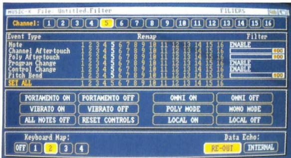
La quarta finestra contiene due tipi di informazioni: a sinistra ci sono i selettori per scegliere con quale delle quattro Keymap lavorare; a destra ci sono i selettori Data Echo che determinano sei i dati, sul canale operativo, dopo essere stati filtrati, vengono diretti all'uscita MIDI o ai suoni interni di Amiga o se non saranno diretti per niente.
