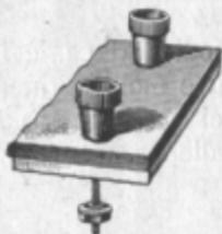
FIG. 29. — Condensatore fisso ma regolabile.
