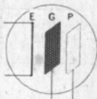
FIG. 23. — Valvola a tre elettrodi - La minima variazione dello stato elettrico del terzo elettrodo - la griglia interposta fra il filamento e la placca - produce una variazione corrispondentemente importante sull'intensità della corrente filamento-placca.
