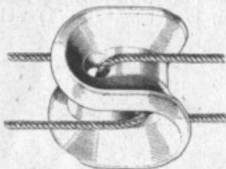
FIG. 2. — Isolatore speciale per antenna.
