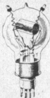
FIG. 13. — Valvola a cornetti per la ricezione di onde corte:
