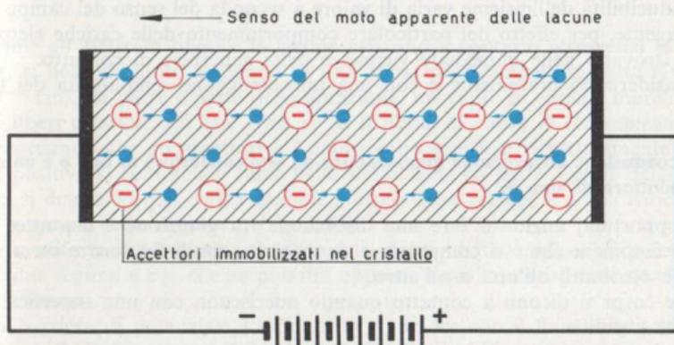
Fig. 2.11 - Conduzione di un semiconduttore di tipo *p*.
