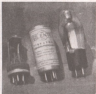
Vibratore silente costruito in Italia, disposto presso una valvola raddrizzatrice per contristarne le dimensioni.
