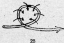
Fig. 25 - Direzione delle linee di forza in un conduttore piegato ad anello.
