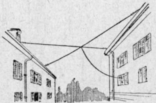
Fig. 86 - Antenna ad X.
