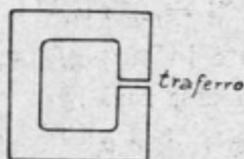
Fig. 29 - Il giunto o traferro.
