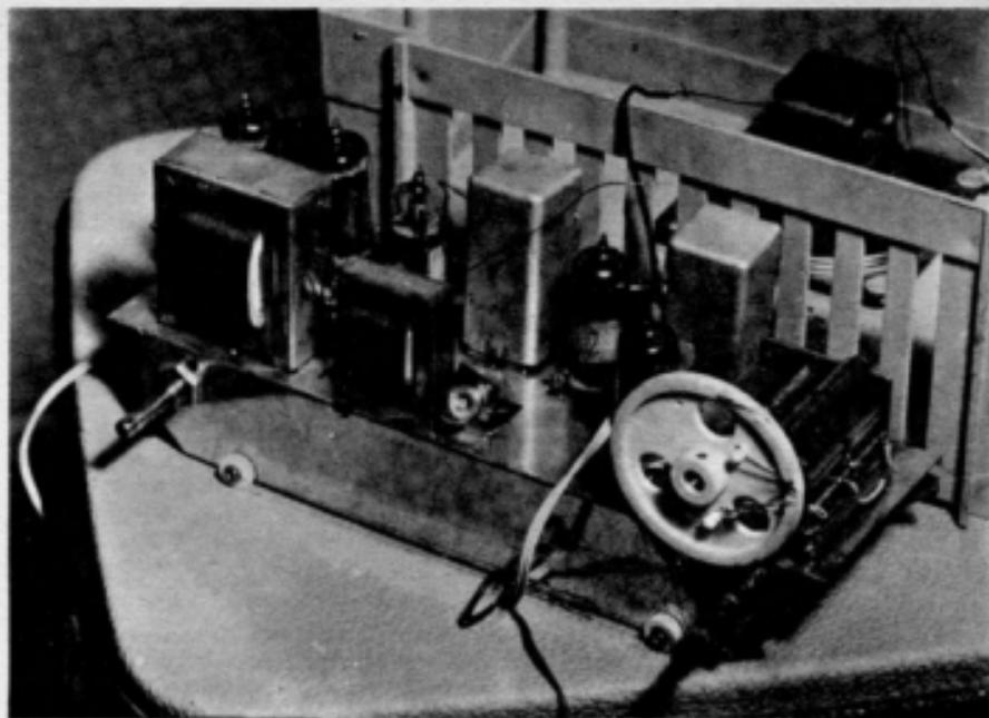
*Ecco il ricevitore con circuito supereterodina completamente montato, prima di essere inserito nel mobile contenitore. Sulla destra si notano i componenti del circuito di alta frequenza; al centro sono alloggiati gli elementi caratteristici degli stadi di media frequenza; sull'estrema sinistra si notano i componenti del circuito di bassa frequenza.*
