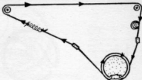
Montaggio funicella dei ricevitori MAGNADYNE modd. 394 - S95 - S171 - S173 - S181. La funicella compie due giri sul perno di comando della sintonia.
