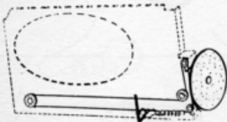
Meccanica della scala parlante del ricevitore a valvole PHONOLA mod. 675B. La funicella deve essere di acciaio della lunghezza di 780 mm, provvista di nodo ad asola su entrambe le estremità.
