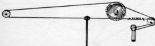
Meccanica della scala parlante dei ricevitori SIEMENS modd. SM738 - 7138. La lunghezza complessiva della funicella è di 130 cm.
