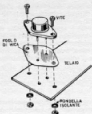
*Sistema di applicazione al telaio metallico di un transistor di potenza di tipo OC 30. Il terminale di collettore di questo speciale tipo di transistor è rappresentato dal suo involucro esterno.*
