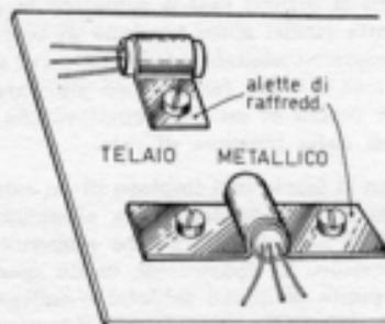
*I dilettanti risolvono molto semplicemente il problema di raffreddamento dei transistori preparando alette di raffreddamento ricavate da lamierini di ferro. Le alette devono rimanere in intimo contatto con il telaio per favorire il fenomeno di conduzione termica.*
