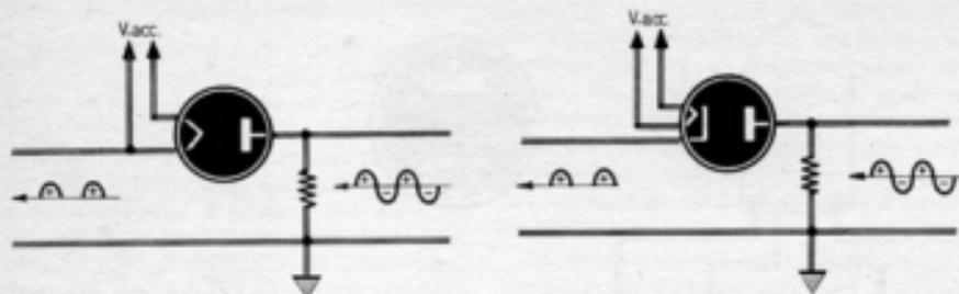
*Il diodo, cioè la valvola elettronica a due elettrodi, viene usato principalmente per raddrizzare le correnti alternate. Quando nella valvola manca il catodo (disegno a sinistra), è lo stesso filamento che si comporta da catodo, perchè da esso si preleva la corrente raddrizzata uscente. Il disegno a destra illustra lo stesso principio con una valvola diodo munita di catodo.*
