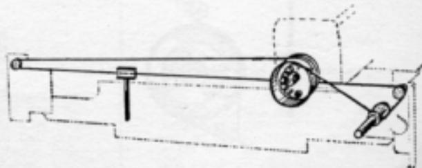
Montaggio della funicella per il funzionamento del selettore del ricevitore PHONOLA mod. AUTORADIO 5521. La lunghezza della funicella è di 500 mm; alle due estremità vengono composte due asole in modo che la lunghezza netta della funicella risulti di 475 mm.
