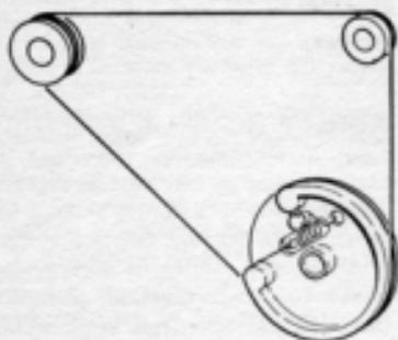
*Montaggio della funicella della scala parlante del ricevitore a transistor **RADIOMARELLI** mod. RD322. La gamma di frequenze si estende fra 0,525 e 1,620 MHz.*
