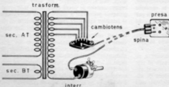
*Il circuito di alimentazione dell'avvolgimento primario del trasformatore prevede l'applicazione di tre elementi: il cambiotensione, l'interruttore (incorporato nel potenziometro) e la spina di rete. Il cambiotensione è collegato ai terminali del trasformatore e ad uno dei due conduttori di rete.*
