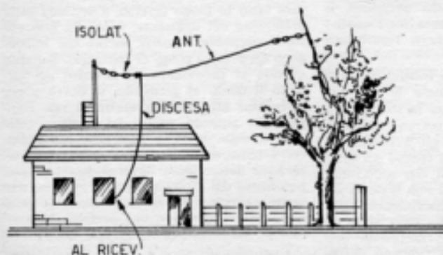
*Il ricevitore a diodo non può funzionare se non è collegato ad un buon impianto di antenna, perchè la unica forma di alimentazione del circuito deriva dalle onde radio presenti nello spazio. Le antenne più efficienti sono sempre quelle esterne, installate come indicato nella figura accanto.*
