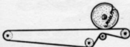
*Meccanica della scala parlante dei ricevitori Philips mod. 371A - 460A - 472A. La funicella è fissata, per mezzo di un nodo, al rotore; essa scorre poi sull'incavo della puleggia posta all'estrema destra; viene avvolta con due giri attorno al perno e fatta scorrere, quindi attraverso gli incavi delle altre due pulegge, per ritornare finalmente al rotore.*
