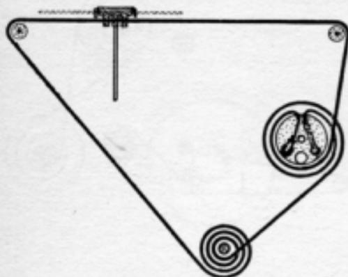
Meccanica della scala parlante dei ricevitori **RADIOMARELLI** mod. 159 - 161 - 162 - 163 - 169. Una delle due estremità della funicella va annodata ad asola e fissata al rotore; la funicella vien fatta girare nel rotore da destra verso sinistra; vien fatta passare poi nella prima puleggia da destra verso sinistra e, successivamente, nella seconda; la funicella deve compiere due giri attorno al perno di comando prima di ritornare al rotore, cui va fissata con la molla di tensione.
