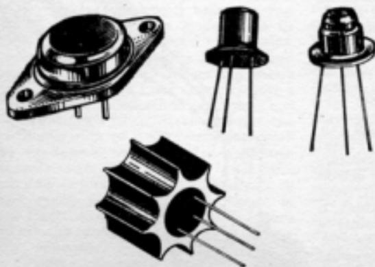
*Alcuni tipi di transistori comunemente usati nei circuiti radioelettrici. Quello in alto a sinistra è un transistor di potenza, munito di due terminali (base ed emittore); il terminale di collettore è costituito dall'involucro metallico del componente. La conformazione del transistor rappresentato in basso agevola la dispersione del calore prodotto.*
