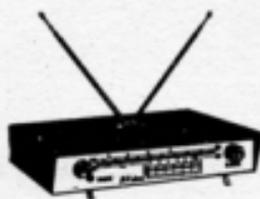
*L'antenna, per ogni ricevitore radio, rappresenta la porta di ingresso per i segnali radio dovunque presenti. Nei ricevitori radio di concezione moderna, adatti per l'ascolto dei programmi a modulazione di frequenza, vengono montate antenne orientabili, di dimensioni ridotte e di tipo « telescopico ».*
