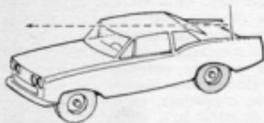
*Soltanto l'antenna installata sul tetto dell'autovettura può vantare la massima ricettività delle onde radio. Questa fondamentale caratteristica risulta limitata quando l'installazione avviene in altre parti della carrozzeria.*
