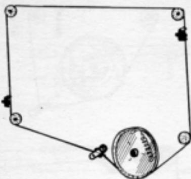
Meccanica della scala parlante del ricevitore a valvole PHONOLA mod. 5535. La lunghezza della funicella di seta è di 900 mm; alle due estremità devono essere eseguiti due nodi ad asola, in modo che la lunghezza netta della funicella risulti di 840 mm.
