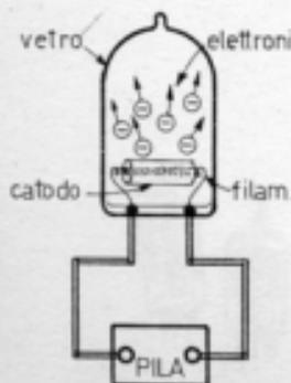
*Il filamento, al passaggio della corrente, diviene incandescente e riscalda il catodo; quest'ultimo, che è un elettrodo formato da un tubetto di acciaio molto piccolo, emette nello spazio circostante un grande numero di elettroni.*
