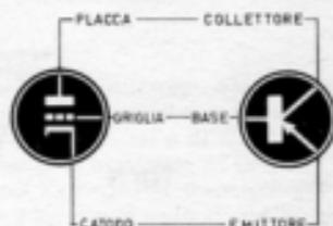
*Il transistor, pur essendo completamente diverso dalla valvola elettronica, trova una certa corrispondenza con questa: il transistor può essere paragonato alla valvola triodo.*
