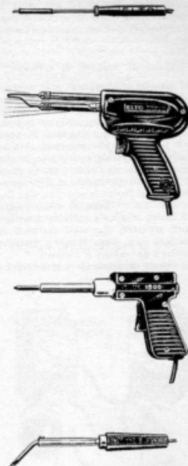
Le figure illustrano quattro tipi diversi di saldatori usati comunemente nei lavori di montaggio e riparazione degli apparati a circuito transistorizzato. Le loro principali caratteristiche sono: punta sottile e una potenza elettrica relativamente bassa.
