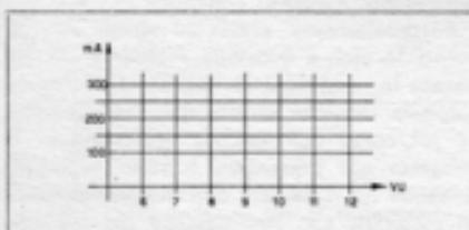
Diagramma delle variazioni del carico. Sull'asse delle ascisse sono riportati i valori delle tensioni di uscita, sull'asse delle ordinate quelli delle correnti. Il carico massimo varia tra 0,3 A. a 6 V. e 0,1 A. a 12 V.
