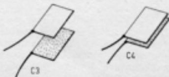
A sinistra: il condensatore nella sua espressione più elementare è rappresentato da due lamine metalliche sulle quali si condensano, affacciate tra di loro, le cariche elettriche.
