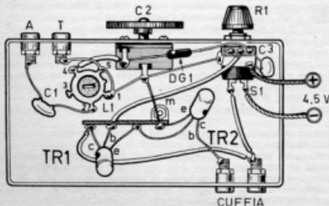
*Il piano di cablaggio del ricevitore a diodo con amplificazione di bassa frequenza deve essere eseguito nel modo indicato in questo schema.*
