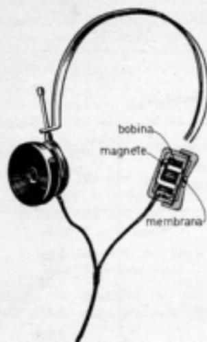
*La cuffia telefonica è un trasduttore acustico il cui funzionamento si basa sui principi di natura elettromagnetica. I due padiglioni auricolari sono tenuti assieme da una molla d'acciaio semicircolare.*
