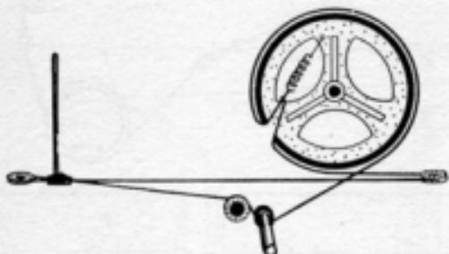
Montaggio della funicella per lo spostamento dell'indice della scala parlante dei ricevitori a valvole SIEMENS mod. SM5123 - SM5022 - SM6133. La lunghezza della funicella è di 100 cm. per il modello SM5123 ed è di 95 cm. per il ricevitore SM5022.
