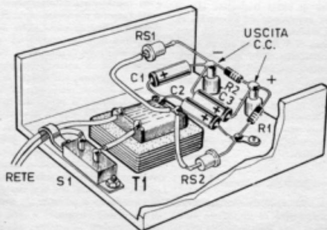
tensione di valori inferiori, dovranno stabilire il valore esatto della resistenza R1 ricorrendo alla legge di Ohm.
