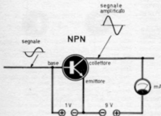
Lo schema elettrico rappresentato in figura indica l'esatto impiego di un transistor di tipo NPN in qualità di amplificatore dei segnali radio.
