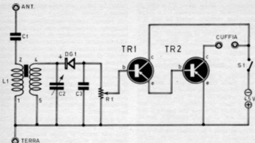
*I componenti del ricevitore sono: C1 = 1.000 pF (condensatore ceramico); C2 = 350 pF (condensatore variabile); C = 500 pF (condensatore ceramico); R1 = 50.000 ohm (potenziometro con interruttore S1 incorporato); L1 = bobina di sintonia di tipo Corbetta CS2; DG1 = diodo al germanio di qualsiasi tipo; TR1 = OC 75 o simile; TR2 = OC 72 o simile.*
