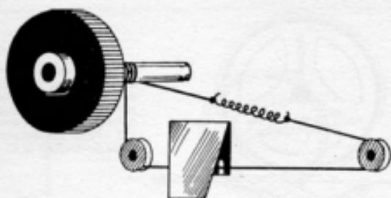
Montaggio della funicella dei ricevitori a valvole SIEMENS modd. 7058 - 7158. In alto è rappresentato lo schema relativo al comando al controllo dei toni alti e bassi. La sua lunghezza è di 26 cm. Il disegno in basso rappresenta lo schema di montaggio della funicella del comando della selettività variabile; la sua lunghezza è di 85 cm.
