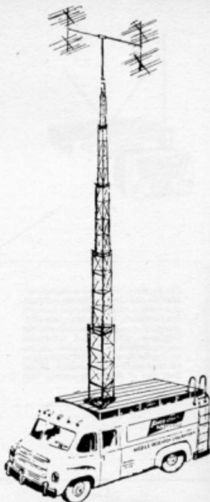
*L'altezza dal suolo dell'antenna trasmittente o ricevente costituisce l'elemento di maggior importanza per la qualità di ogni tipo di collegamenti radio. Anche le antenne delle trasmissioni mobili TV tendono ad esaltare tale elemento.*
