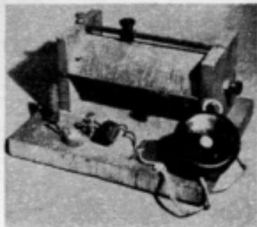
*Siamo ai primordi della radio. I ricevitori a detector, con ascolto in cuffia telefonica, erano privi del condensatore variabile. Le variazioni di accordo, nel circuito, di sintonia, si ottenevano facendo scorrere un cursore lungo le spire della bobina.*
