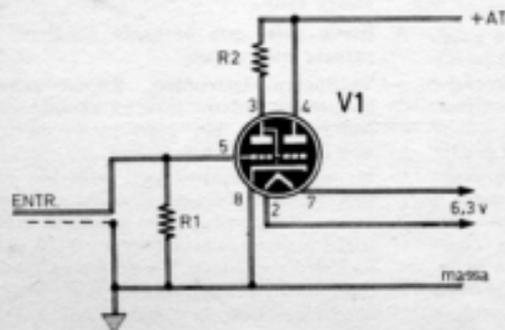
Schema elettrico di un circuito con valvola indicatrice di sintonia di tipo 6E5. I componenti sono: R1 = 2 megohm — 1 watt; R2 = 2 megohm — 1 watt; V1 = 6E5.
