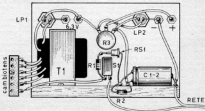
tutto per l'impiego di un autotrasformatore e di pochi componenti elettronici.
