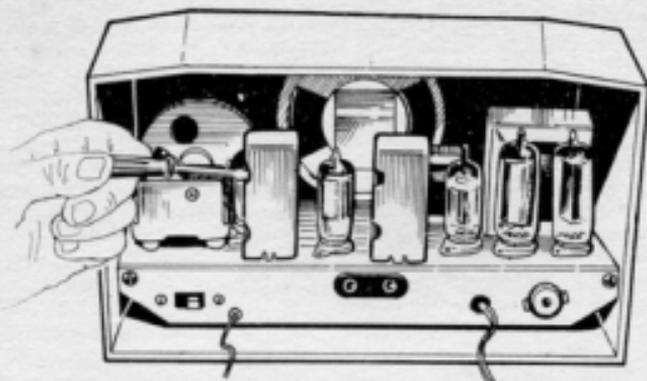
La taratura delle medie frequenze di un ricevitore a circuito supereterodina si può effettuare in due diverse maniere: ad orecchio oppure con l'ausilio dell'oscillatore modulato. In entrambi i casi si avvitano o si svitano i nuclei dei due trasformatori di media frequenza, cominciando con i due della prima MF per terminare con quelli della seconda MF.
