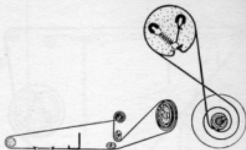
Montaggio funicella della scala parlante del ricevitore **RADIOMARELLI** modd. 171 - 176 - 178 - 183. Il disegno in alto illustra le meccaniche dei comandi di sintonia **MA** (a destra) ed **MF** (a sinistra). Il disegno al centro illustra la meccanica del comando di sintonia a modulazione d'ampiezza; quello in basso illustra, in ogni particolare, la meccanica di sintonia per la ricezione in modulazione di frequenza.
