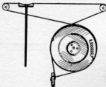
Meccanica della scala parlante del ricevitore PHONOLA mod. 5519. La lunghezza della funicella è di 1270 mm. Dopo aver eseguiti due nodi alle estremità, la lunghezza utile della funicella è di 1200 mm.
