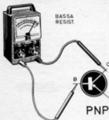
Applicando il puntale positivo dell'ohmmetro sulla base del transistor e il puntale negativo sul collettore, lo strumento dovrà segnalare un valore basso di resistenza se il transistor è di tipo PNP.
