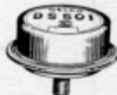
tensione dell'ordine di 0,5 volt, si deve concludere che il transistor in esame è di tipo al silicio. I valori indicati risultano di 0,1 volt circa più bassi nel caso di transistori di potenza.
