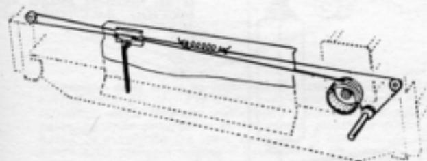
Meccanica della scala parlante dei ricevitori a valvole PHONOLA modd. 676 - 678. Occorrono una funicella metallica della lunghezza di 260 mm. ed una di seta della lunghezza di 756 mm.
