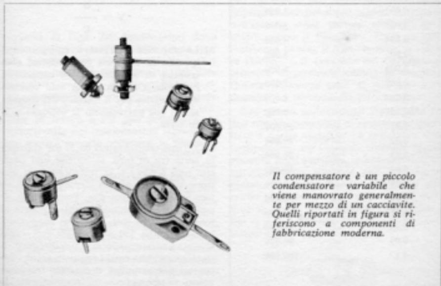
*Il compensatore è un piccolo condensatore variabile che viene manovrato generalmente per mezzo di un cacciavite. Quelli riportati in figura si riferiscono a componenti di fabbricazione moderna.*
