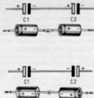
Collegamento in serie (sopra) di due condensatori elettrolitici. Per ottenere un condensatore di capacità molto elevata, in sostituzione di un normale condensatore fisso, si possono collegare tra loro due condensatori elettrolitici (sotto), purché la congiunzione avvenga fra due terminali dello stesso nome (positivi o negativi).
