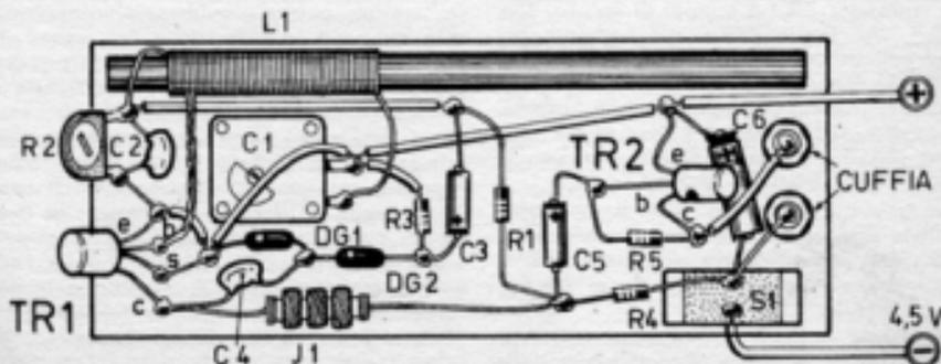
ficatore funziona in un primo tempo da amplificatore AF e in un secondo tempo da amplificatore BF.
