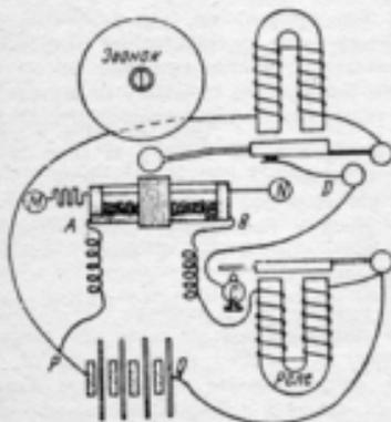
Schema di principio dello storico apparato ricevente ideato e realizzato da Alessandro Popov. Il dispositivo si differenzia solo in particolari di ordine secondario da quello inventato da Guglielmo Marconi.
