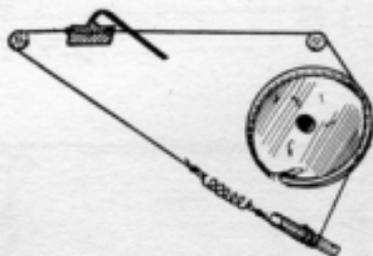
Meccanica della scala parlante dei ricevitori a valvole PHONOLA mod. 5539 - 5541R - 5543R. La lunghezza della funicella è di 720 mm; in essa vengono praticati tre nodi ad asola: uno ad una estremità, un secondo a 215 mm. dal primo ed un terzo alla estremità opposta.
