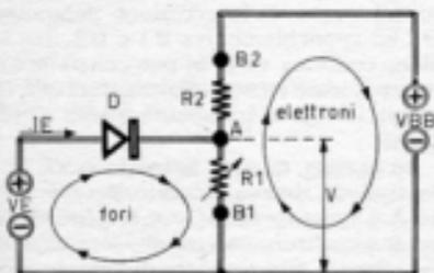
Circuito elettrico equivalente al circuito interno di un transistor unigiunzione. Fra i terminali di entrata appare una resistenza dinamica negativa, che viene utilizzata nelle applicazioni pratiche.
