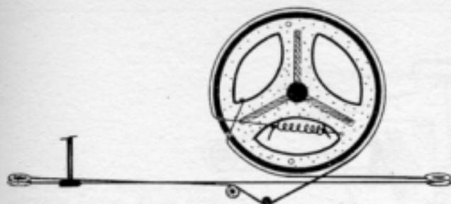
Montaggio della funicella per lo spostamento dell'indice della scala parlante dei ricevitori a valvole SIEMENS mod. 533 - 6033. La lunghezza della funicella è di 95 cm.
