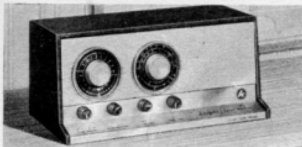
*Per l'ascolto di tutte le emittenti mondiali occorre un ricevitore munito di più gamme d'onda, come quello qui presentato. Si tratta di apparecchio di fabbricazione americana, venduto in scatola di montaggio e dotato di ben quattro gamme d'onda.*
