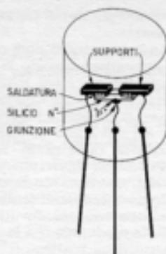
Vista in sezione di un transistor unigiunzione, chiamato anche diodo a doppia base. Si riconoscono i suoi tre elettrodi: prima base (a sinistra), emittore (al centro), seconda base (a destra).
