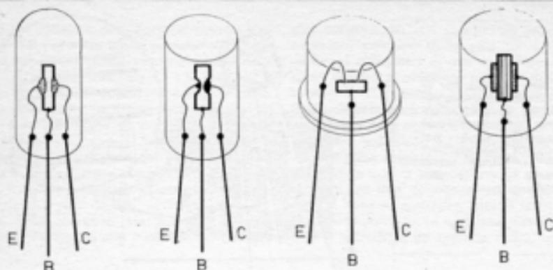
*Vista in sezione, schematizzata, di quattro tipi fondamentali di transistor. Nell'ordine, da sinistra a destra: transistor con giunzione a lega; transistor a barriera di superficie; transistor a contatti puntiformi; transistor di tipo drift.*
