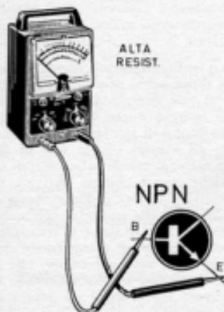
Applicando il puntale positivo dell'ohmmetro sulla base del transistor e quello negativo sull'emittore, lo strumento dovrà segnalare un valore elevato di resistenza se il transistor è di tipo NPN.
