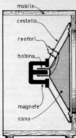
*L'altoparlante rappresenta il piú importante tipo di trasduttore acustico usato in radiotecnica. Ve ne sono in commercio di tutti i tipi, di tutte le forme e di diverse potenze. La composizione del componente è, tuttavia, sempre la stessa: cono, bobina mobile, magnete permanente e cestello.*
