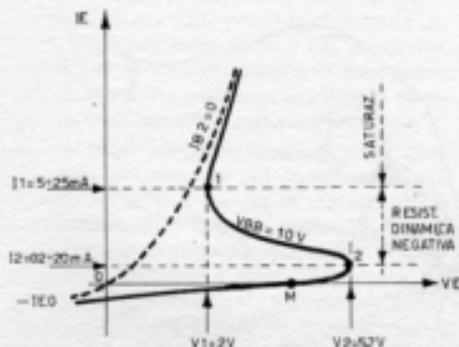
Curve caratteristiche del circuito di entrata di un transistor unigiunzione. Quando la corrente  $IB2 = 0$ , si ritrova la curva (tratteggiata) classica di un diodo. La curva del transistor unigiunzione è a tratto pieno e presenta una zona di resistenza dinamica negativa.
