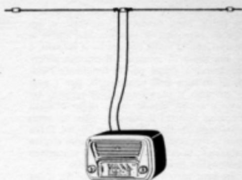
*Le antenne unifilari esterne, installate ad una notevole altezza dal suolo, rappresentano sempre i « captatori di onde » più efficienti, e quelli che assicurano la migliore ricezione dei programmi radiofonici. L'antenna esterna esalta la sensibilità dell'apparecchio radio e lo « isola » da taluni tipi di disturbi.*
