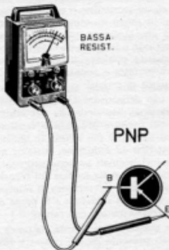
Applicando il puntale positivo dell'ohmmetro sulla base e quello negativo sull'emittore, lo strumento dovrà segnalare un basso valore di resistenza se il transistor in esame è di tipo PNP.
