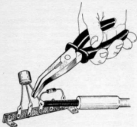
*La tecnica della saldatura degli elettrodi dei transistor impone sempre un sistema di dispersione del calore. Il più comune tra questi consiste nello stringere gli elettrodi fra i becchi di una pinza metallica.*
