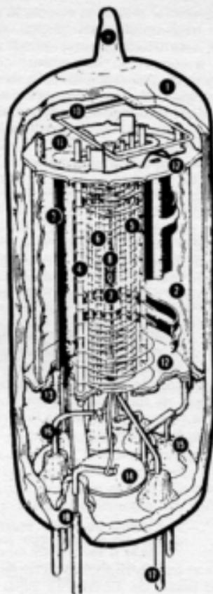
Vista in « spaccato » di una valvola elettronica multigriglia. Gli elementi indicati numericamente sono: 1-Involucro di vetro; 2-Schermo interno; 3-Placca; 4-Griglia soppressore; 5-Griglia schermo; 6-Griglia controllo; 7-Catodo; 8-Filamento; 9-Tubicino per la creazione del vuoto; 10-Getter (perfeziona il vuoto spinto); 11-Supporto; 12-Supporto isolante in mica; 13-Supporto inferiore; 14-Base interna; 15-Saldatura vetrosa; 16-Collegamento degli elettrodi sui piedini; 17-Base piedini; 18-Piedini.
