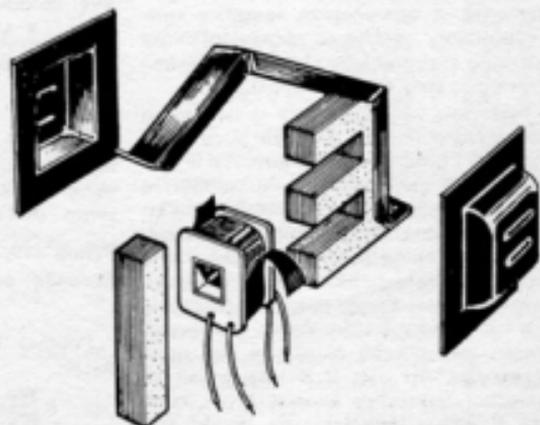
costruzione del trasformatore di alimentazione. Tuttavia, coloro che intendono trasformare la passione per la radio in una attività artigianale, per poterne trarre un utile apprezzabile, devono saper costruire anche il trasformatore di alimentazione. E se in pratica si tratta di realizzare un componente di piccola potenza, allora vale proprio la pena di costruirlo, specialmente se si è in possesso di una piccola bobinatrice.
