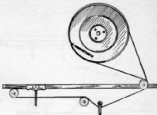
Meccanica della scala parlante dei ricevitori a valvole PHONOLA modd. 676 - 678. Per questo tipo di scala occorrono una funicella d'acciaio della lunghezza di 260 mm. e una di seta della lunghezza di 756 mm.
