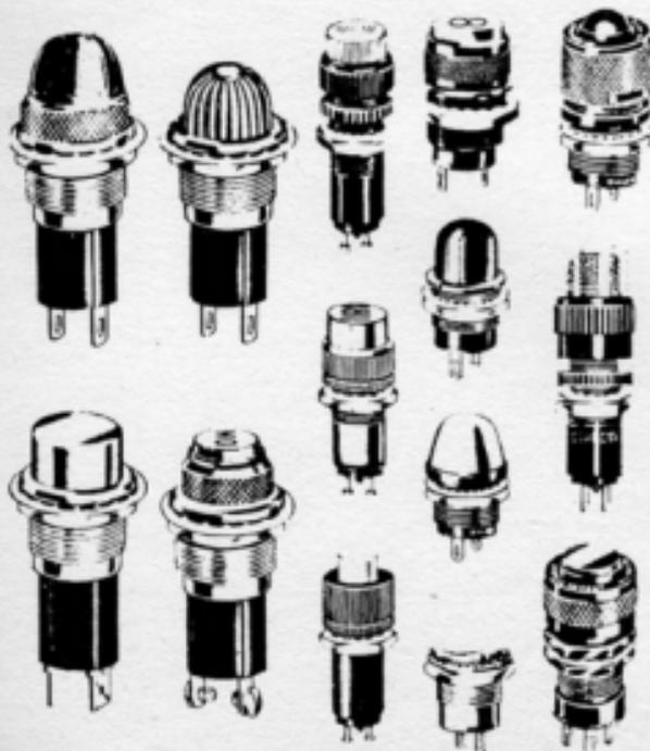
Le lampade-spia trovano larga applicazione in tutti i radioapparati e specialmente negli amplificatori e negli alimentatori. In commercio ve ne sono di tutti i tipi. La colorazione della luce è generalmente quella rossa, ma si possono trovare anche luci diversamente colorate. Il porta-lampada è costruito in modo da poter essere agevolmente applicato su un foro praticato sul telaio metallico.
