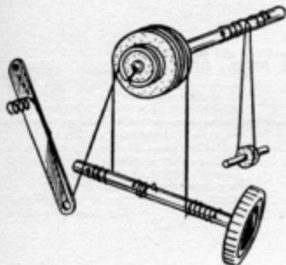
Meccanica della scala parlante dei ricevitori **RADIOMARELLI** mod. 9 U 65 - 9 A 75 - 9 A 85 - 9 A 95. Le funicelle, in questo particolare tipo di meccanica, sono in numero di tre: quella avvolta sul perno in alto sostiene gli equipaggi; quella avvolta all'estrema destra del perno in basso comanda il tamburo; quella all'estrema sinistra guida l'indice della scala.
