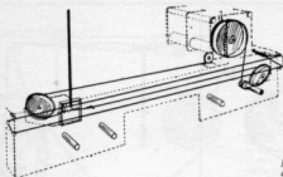
Montaggio funicella e indice del ricevitore PHONOLA mod. 661. Per questo tipo di scala occorrono due diverse funicelle: una di seta della lunghezza di 460 mm. e una di acciaio della lunghezza di 678 mm.
