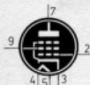
Simboli radioelettrici di due tipi di valvole elettroniche molto comuni. A sinistra è il simbolo della EL84, che è un pentodo finale B.F. (zoccolo noval). A destra è il simbolo della UBC41, che è un doppio diodo-triodo preamplificatore B.F. rivelatore (zoccolo rimlock).
