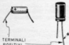
*I condensatori elettrolitici sono componenti elettronici polarizzati, sono cioè dotati di un terminale positivo ed uno negativo; il riconoscimento del terminale positivo è agevolato dalla presenza di una crocetta impressa sull'involucro esterno del componente; talvolta il terminale positivo è rappresentato dal conduttore più lungo.*
