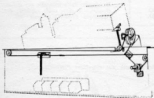
Meccanica della scala parlante del ricevitore PHONOLA mod. 599. La lunghezza della funicella è di 685 mm, e deve essere annodata ad asola, sulle due estremità, in modo che la lunghezza netta risulti di 652 mm.
