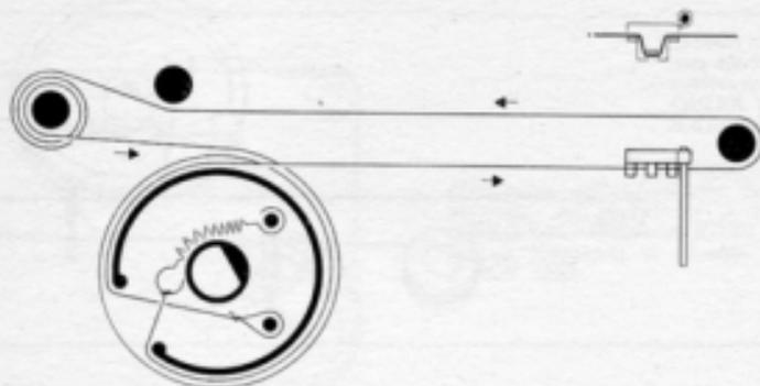
Montaggio funicella della scala parlante del radiofonografo
