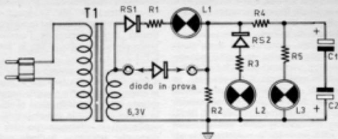
*Il provadiodi, il cui schema teorico è rappresentato qui sopra, è montato (vedi disegno raffigurato sotto) in una cassetina metallica sulla cui parte superiore sono visibili le calotte diversamente colorate che ricoprono le tre lampade-spia. Sulle boccole si applicano i raddrizzatori al silicio in prova. Internamente alla cassetina è montato il circuito dell'apparecchio.*
