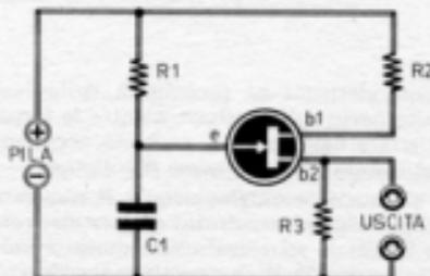
Esempio di circuito di oscillatore a rilassamento. Componenti R1 = 5 — 100.000 ohm; R2 = 100 ohm; R3 = 25 ohm; C1 = 100.000 pF; pila = 12-30 V.
