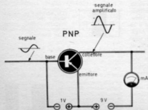
Lo schema elettrico rappresentato in figura indica l'esatto impiego di un transistor di tipo PNP in qualità di amplificatore dei segnali radio.
