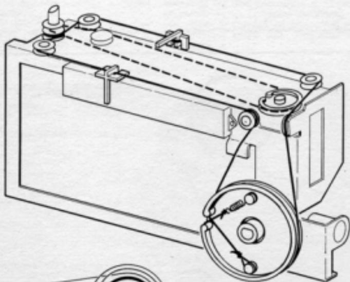
*Funicella della scala parlante del ricevitore a transistor **RADIOMARELLI** mod. RD320.*
