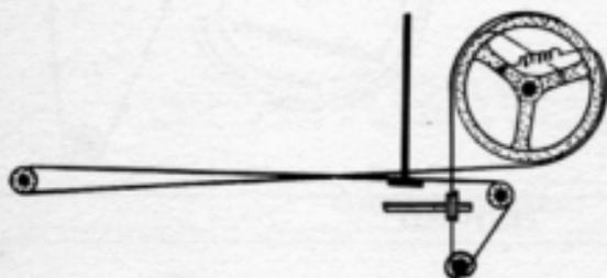
Meccanica della scala parlante dei ricevitori a valvole SIEMENS mod. SM522 - 524. Il comando di sintonia si compone di due distinti sistemi: quello che comanda la variazione di permeabilità e quello che comanda l'indice della scala.
