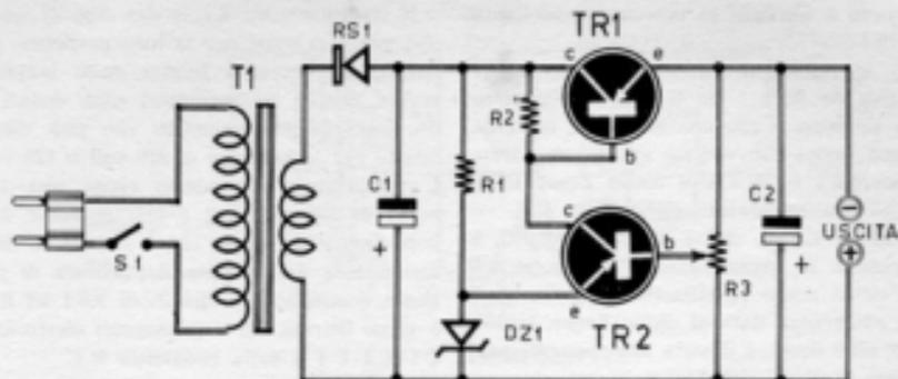
L'alimentatore stabilizzato monta, principalmente, un trasformatore di alimentazione, un raddrizzatore al selenio, due transistor e un diodo Zener. Si noti, nel disegno sotto riportato, il particolare sistema di montaggio del diodo Zener DZ1, che favorisce la rapida dispersione del calore prodotto dal componente.
