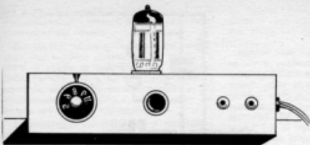
*Così si presenta esternamente, a montaggio ultimato, il ricevitore a rivelazione diretta impiegante una valvola elettronica a due sezioni triodiche.*
