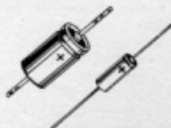
Poichè il « coulomb » rappresenta l'unità di misura della quantità di elettricità o di carica elettrica corrispondente ad 1 ampère al secondo, si può dire che la capacità di un condensatore esprime in generale quel numero costante di coulomb che devono essere di volta in volta dislocati sulle armature affinché la tensione tra l'una e l'altra si elevi ogni volta e progressivamente di 1 volt.
