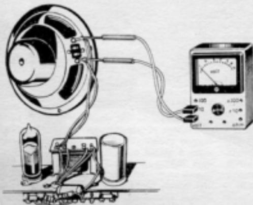
Il sistema della taratura ad orecchio può essere aiutato con l'uso del tester commutato nella posizione di misura delle tensioni. I puntali dello strumento vanno applicati ai terminali della bobina mobile dell'altoparlante; i nuclei delle medie frequenze vengono ruotati fino ad individuare il punto in cui la tensione misurata dallo strumento è massima.
