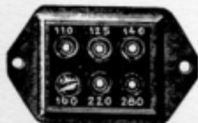
*Il cambiotensione è un componente assai importante per tutti i tipi di ricevitori radio alimentati con la tensione di rete. Esso permette di adattare l'avvolgimento primario del trasformatore di alimentazione al corrispondente valore della tensione. Nelle figure sono riportati alcuni esempi di questo componente. A sinistra i tipi più vecchi e, a destra, quelli di modernissima concezione.*
