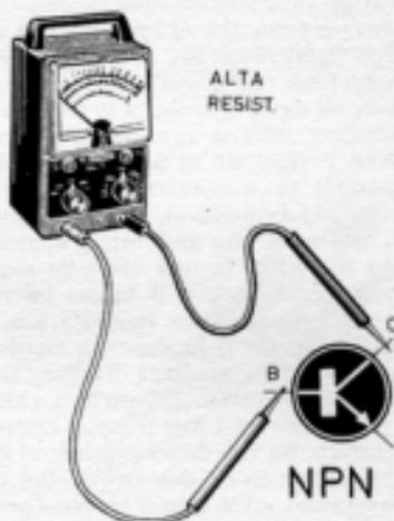
Applicando il puntale positivo dell'ohmmetro sulla base del transistor e quello negativo sul collettore, lo strumento dovrà segnalare un valore elevato di resistenza se il transistor è di tipo NPN.
