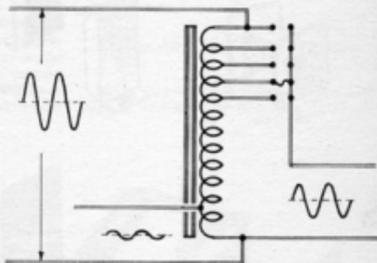
*L'autotrasformatore svolge le stesse funzioni del trasformatore. È meno ingombrante di quest'ultimo e viene montato nei ricevitori radio di media potenza e di costruzione economica.*
