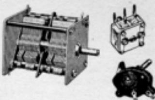
Sotto a sinistra: la capacità di un condensatore dipende dalla misura delle superfici delle lamine metalliche e dalla loro distanza. La capacità del condensatore C1 è inferiore a quella del condensatore C4 ed è superiore a quella del condensatore C3.
