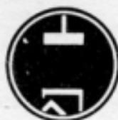
*Il diodo, il cui simbolo è rappresentato sulla destra, costituisce il tipo più semplice di valvola elettronica. Gli elettroni emessi dal catodo sono attratti dalla placca, sulla quale è applicata la tensione positiva della pila anodica.*
