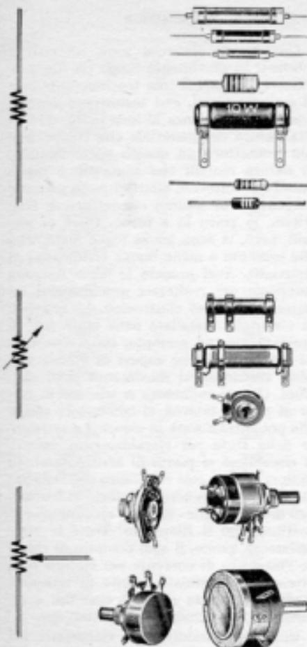
*Resistenze radioelettriche in simboli (a sinistra) e nel loro aspetto reale (a destra). Le prime, in alto, sono resistenze fisse di tipo chimico; quelle al centro sono resistenze a filo e variabili (il simbolo caratterizza la resistenza di tipo semifisso); in basso sono rappresentate le resistenze variabili, chiamate anche col nome di « potenziometri »: questi ultimi possono essere di tipo a strato di grafite e a filo (reostati).*
