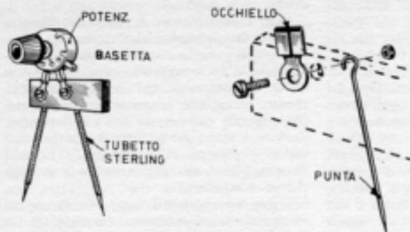
*Il compasso che permette di determinare il valore esatto delle resistenze, si compone di due puntali, due capofili, una piastrina di bachelite e un potenziometro. I due puntali sono inguainati con spezzoni di tubo sterling.*
