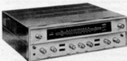
*Assomiglia ad un moderno e lussuoso ricevitore a transistori, invece è un apparato ricetrasmittitore portatile, con alimentazione a pile. Lo si può usare dovunque senza alcuna speciale installazione. Il trasmettitore ha una potenza di 0,5 watt e monta 18 transistori e 2 valvole. Il ricevitore è a circuito supereterodina a doppia conversione di frequenza.*
