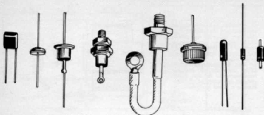
*I diodi semiconduttori, che rappresentano dei componenti di modernissima concezione, trovano svariate applicazioni nei moderni circuiti elettronici. Nei circuiti radioelettrici, in particolare, vengono attualmente e abbondantemente usati i diodi al silicio in veste di elementi raddrizzatori della corrente alternata prelevata dalla rete-luce.*
