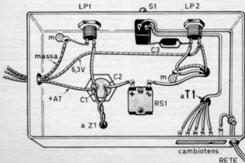
*Il circuito dell'alimentatore sperimentale, da abbinarsi ai ricevitori descritti nel precedente capitolo, deve essere realizzato su telaio metallico, che funge da conduttore unico di massa.*
