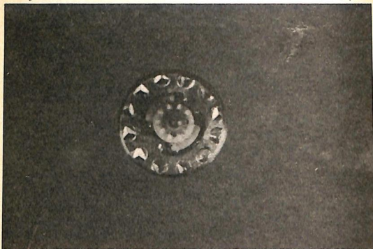
Fig. 4.- Rotore di un motore ad induzione, formato da dischi contigui cortocircuitati sui bordi.
