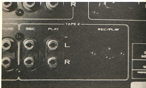
Fig. 7.-Connettori di registratore e preamplificatore. Quando si collega un registratore al preamplificatore la connessione si può effettuare con uno qualsiasi dei tipi di connettore DIN o CINCH. Però si deve utilizzare solo una di tali connessioni (la stessa per entrambi gli apparecchi).
