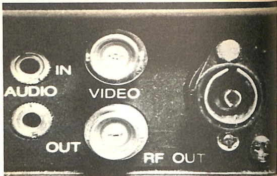
Fig. 4.-Connettore BNC femmina di ingresso (IN) e uscita (OUT) video, sul pannello di collegamento di un videoregistratore.
