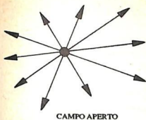
Fig. 2.-In campo aperto le onde provengono solo dalla sorgente sonora, e la loro energia diminuisce con la distanza. Invece, quando la sorgente emette in un locale chiuso, le onde sonore provengono dalla sorgente, e dalle pareti per riflessione. Il livello sonoro sarà superiore a quello del campo libero.
