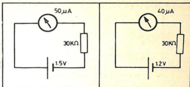
Fig. 2.-Errore di misura di una resistenza, dovuto all' invecchiamento della pila, a causa della semplicità del sistema proposto.
