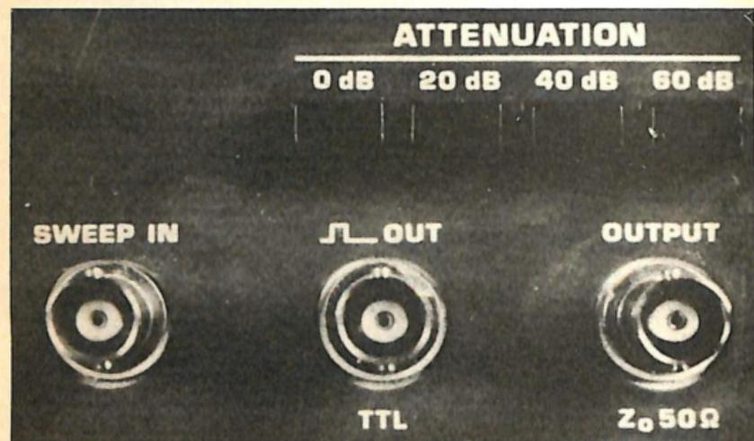
Fig. 6.-Dettaglio dei connettori di ingresso e di uscita. Quello di sinistra si utilizza per l'ingresso del segnale esterno di spazzolamento, e gli altri sono le due uscite: una speciale per l'onda quadra e l'altra generale.
