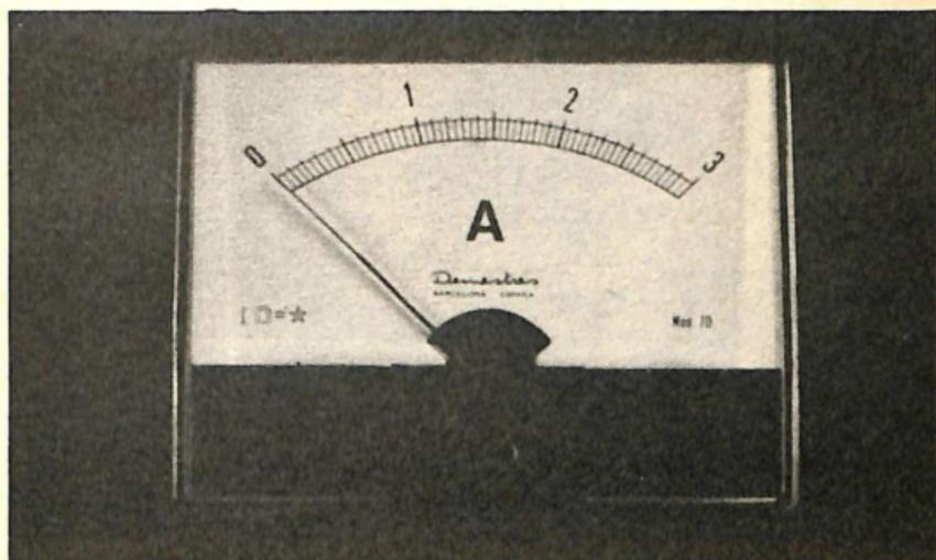
Fig. 4.-Amperometro a bobina mobile. Realizza misure in corrente continua. Entrambe le caratteristiche sono indicate dai simboli posti sulla sinistra.
