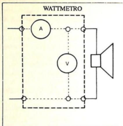
Fig. 12.-Modo corretto di collegare un wattmetro. Si deve osservare che ha quattro terminali, due per la misura della corrente e due per la misura della tensione.
