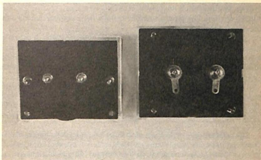
*Fig. 8.-Vista posteriore di due amperometri. Quello di sinistra è a ferro mobile, e non necessita di nessuna indicazione di polarità. Quello di destra è a bobina mobile, essendo indicata la polarità con il segno + posto sulla connessione di sinistra.*
