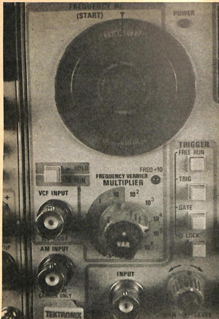
Fig. 7.-Dettaglio dei comandi di controllo di frequenza, che operano in modo simile a quelli del modello precedente.
