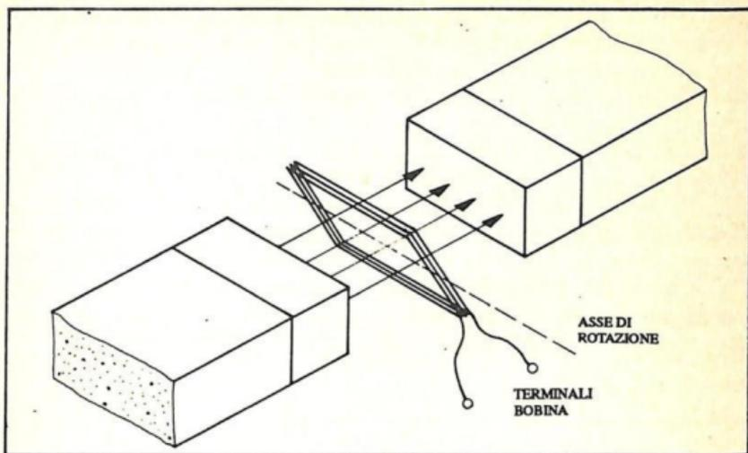
Fig. 4.-Bobina all'interno di un campo magnetico.
