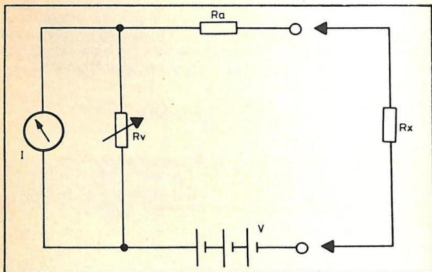
Fig. 4.-Sistema di misura di resistenze, con una regolabile in parallelo.
