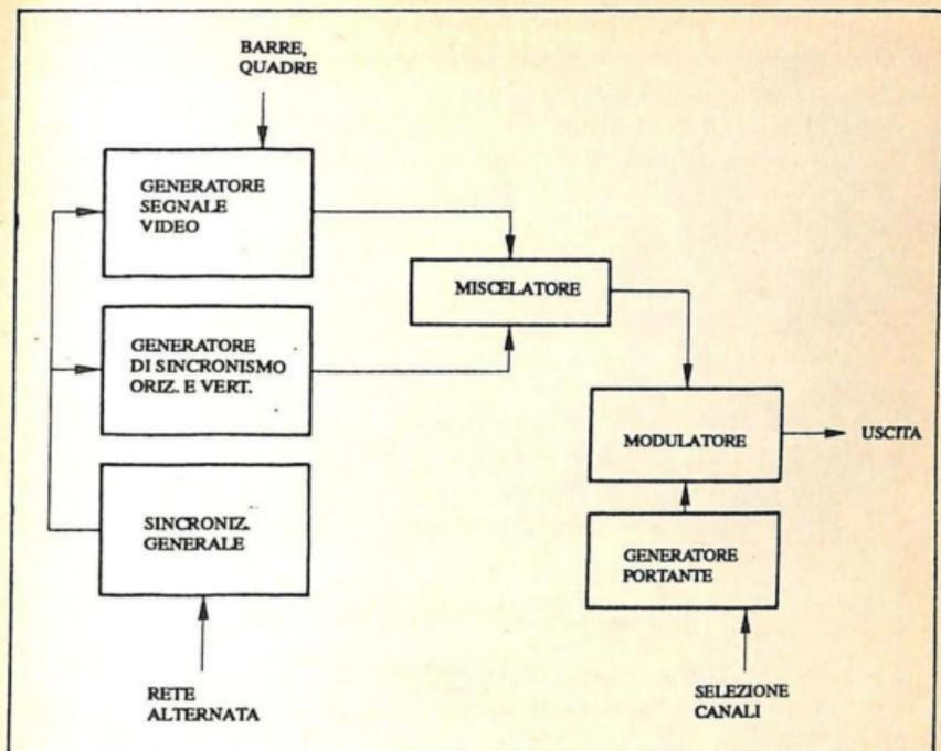
Fig. 3.-Schema funzionale di un generatore di segnali.
