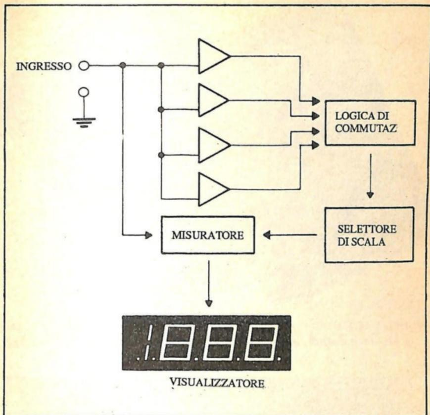
Fig. 13.-Schema a blocchi completo del tester.
