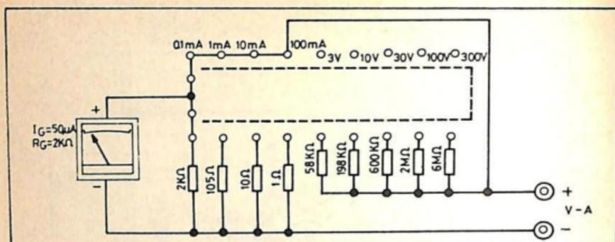
Fig. 3.-Schema elettrico di un voltmetro.
