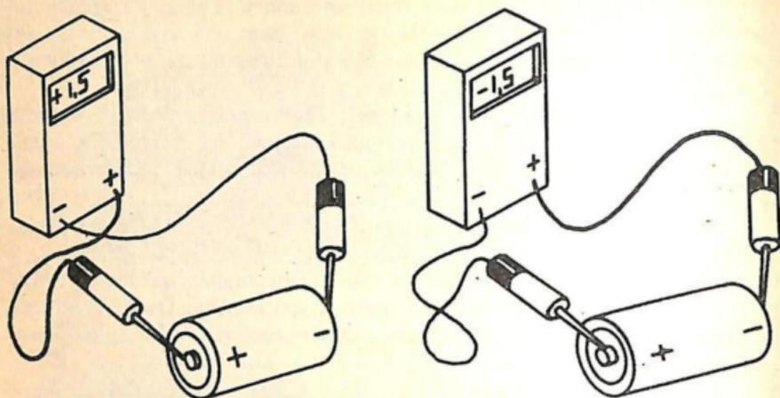
*Fig. 10.-In un tester digitale non è necessario tenere conto del verso di circolazione della corrente, poichè sarà lo stesso strumento a segnalarlo.*
