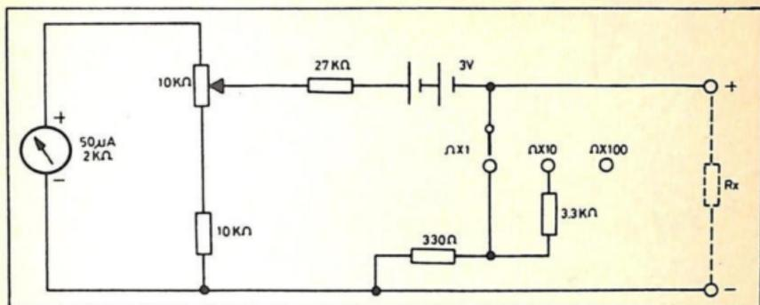
Fig. 5.-Schema pratico di un Ohmmetro a tre scale, con valori centrali di 33 K $\Omega$ , 3,3 K $\Omega$ , 330  $\Omega$ .
