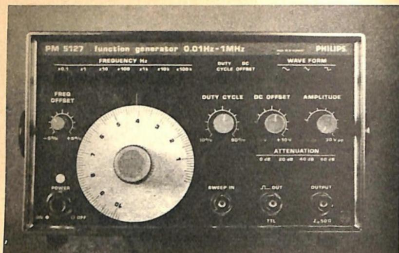
Fig. 1.-Generatore di funzioni di tipo medio. Questo modello può generare le tre forme d'onda di base: sinusoidale, triangolare e quadra.
