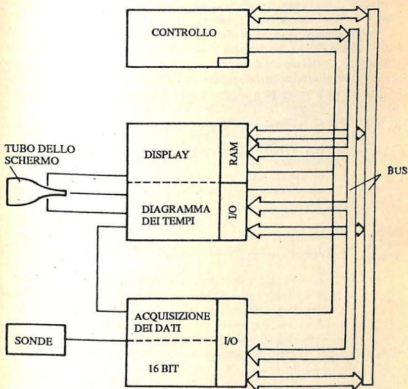
Fig. 17.-Diagramma a blocchi di un analizzatore logico.
