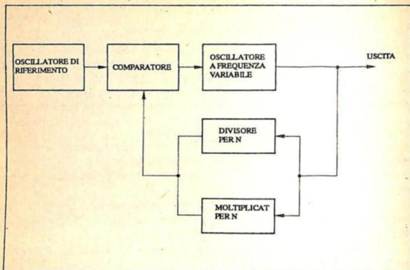
Fig. 9.-Principio di funzionamento teorico di un sintetizzatore.
