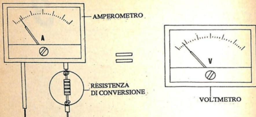
Fig. 1.-Un amperometro con l'aggiunta di una resistenza è perfettamente somigliante a un voltmetro.
