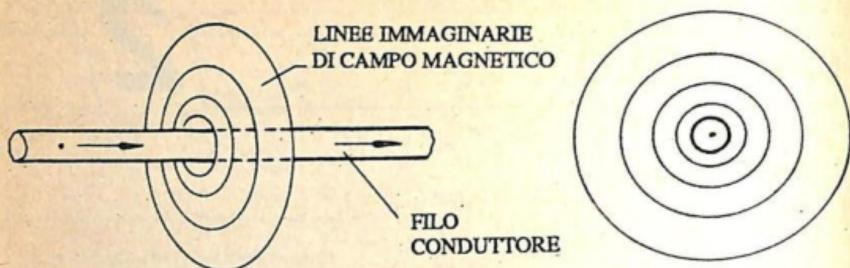
Fig. 1.-Corrente elettrica che circola in un filo conduttore e campo magnetico da lei creato, osservati da due differenti punti.
