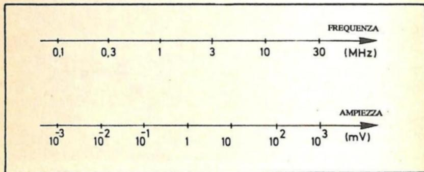
Fig. 8.-Margini di frequenza e segnale per un generatore di radiofrequenza.
