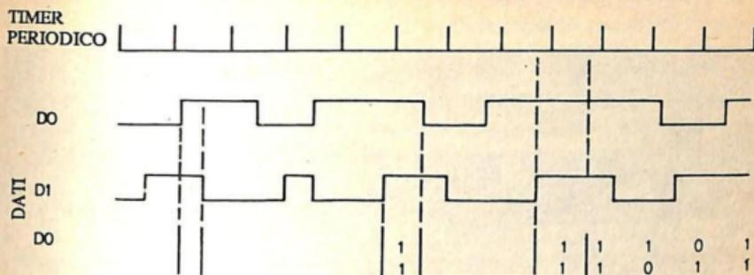
Fig. 19.-Sistema di acquisizione dati asincrono.
