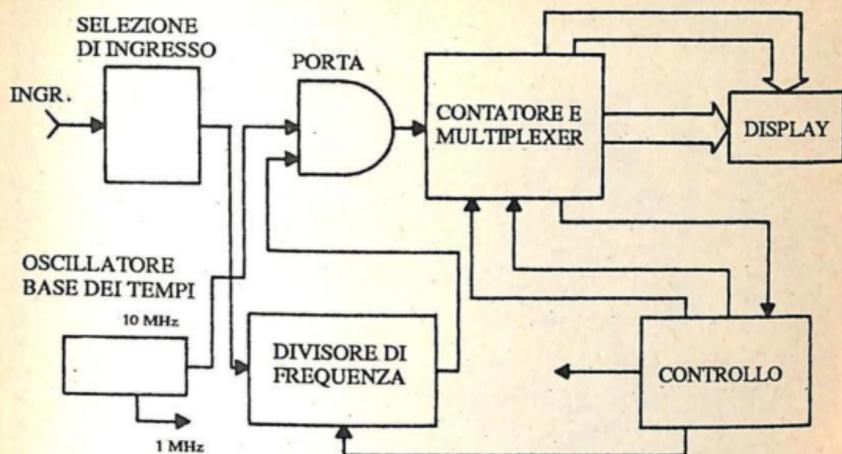
Fig. 8.-Diagramma a blocchi del frequenzimetro, nel funzionamento come misuratore di periodi.
