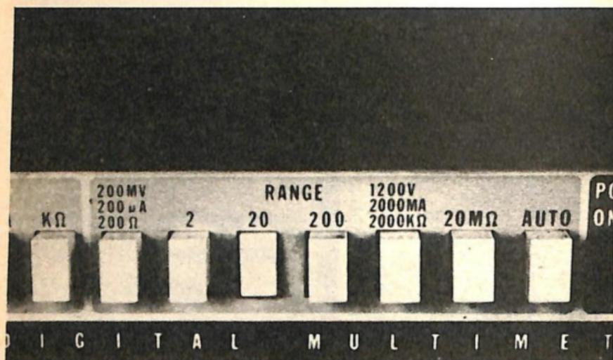
Fig. 6.-Posizioni di misura sul selettore di un tester digitale.
