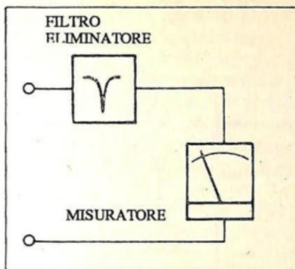
Fig. 13.-I distorsimetri eliminano la parte del segnale di uscita di un amplificatore la cui frequenza è uguale a quella di ingresso, e misurano il livello di ciò che resta. La comparazione con il livello di riferimento darà la percentuale di distorsione.
