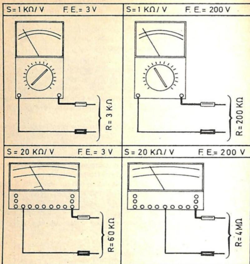
Fig. 3.-Resistenza effettiva in funzione di ciascuna scala.
