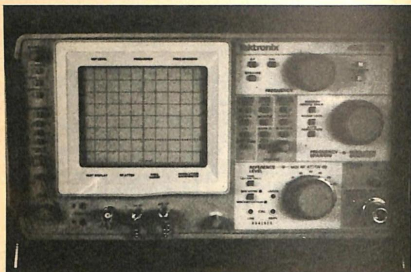
Fig. 9.-Analizzatore di spettro per effettuare misure in alta frequenza.
