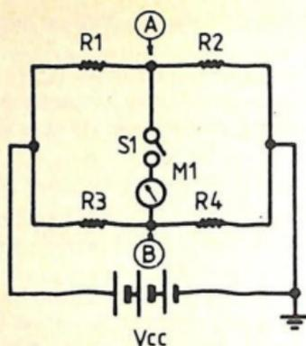
Fig. 2.-Ponte a resistenze.
