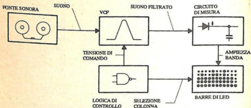
Fig. 14.-Principio di funzionamento di un analizzatore audio suddiviso a blocchi.
