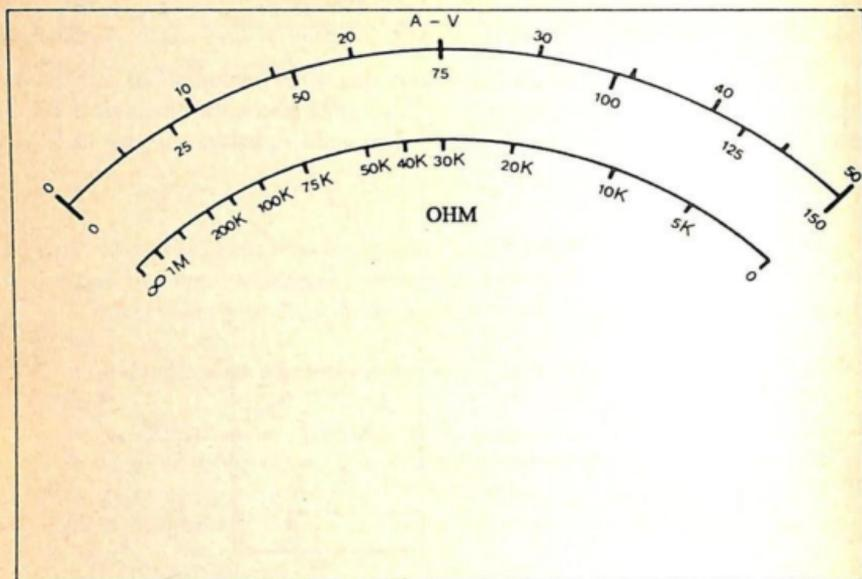
Fig. 2.-Scale da integrare nel galvanometro con i valori proposti dal testo.
