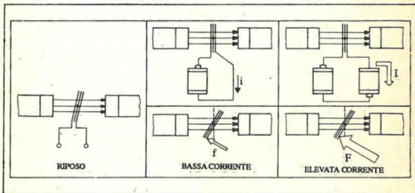
Fig. 5.-Effetto dell'intensità di corrente.
