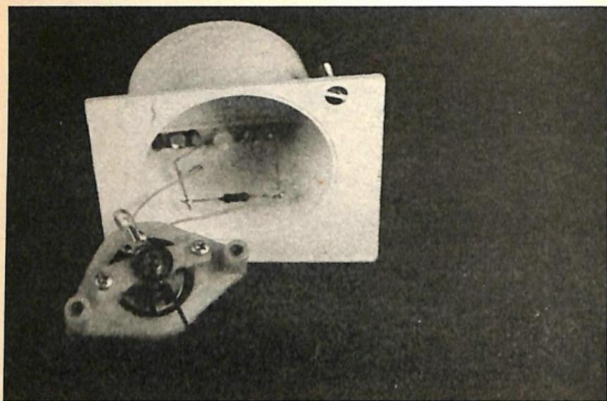
*Fig. 5.-Vista interna di un amperometro a bobina mobile. Si può osservare la resistenza di shunt e la bobina situata sul magnete che forma il nucleo centrale.*
