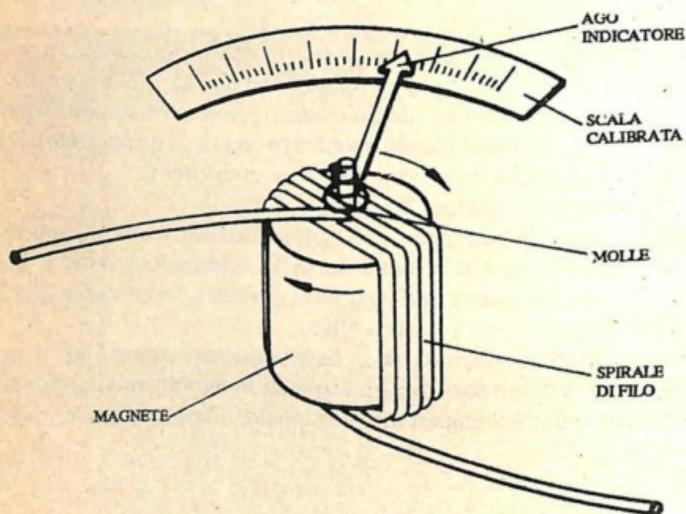
Fig. 2.-Principio di funzionamento del sistema a bobina mobile. L'ago si ferma all'equilibrarsi delle forze della molla e della bobina.
