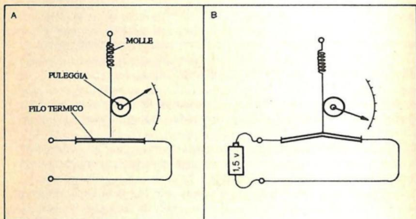
Fig. 15.-Principio di funzionamento di uno strumento di tipo termico.
