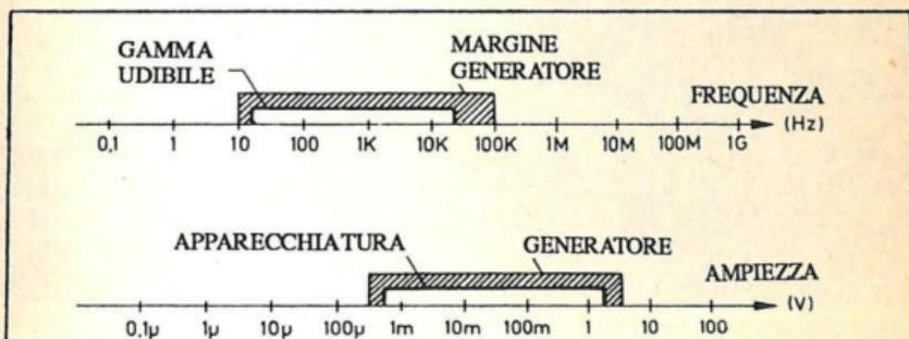
Fig. 4.-Margini consigliabili di frequenza e ampiezza per un generatore audio.
