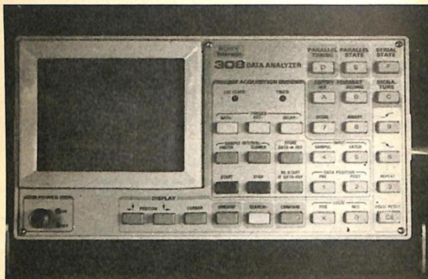
Fig. 16.-Aspetto di un analizzatore logico in un modello convenzionale, nel quale tutti i controlli si effettuano con la tastiera.
