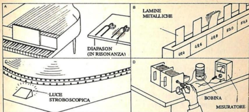
Fig. 5.-Diversi metodi per misure di frequenze. A) Con il diapason. B) Con lamine vibranti. C) Con uno stroboscopio. D) Con un circuito sintonizzato.
