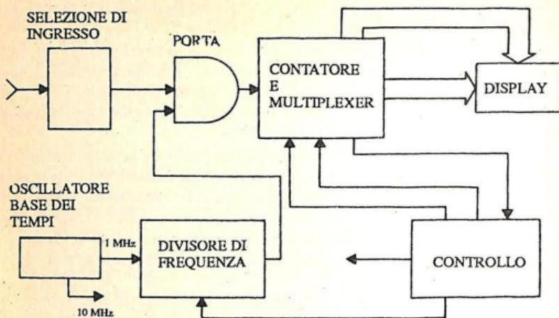
Fig. 7.-Schema a blocchi del frequenzimetro nel funzionamento come misuratore di frequenze.
