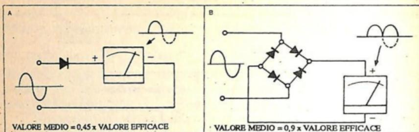
Fig. 10.-L'intensità di corrente media che circola in un misuratore è rapportata con i suoi valori per fattori costanti che dipendono dal tipo di raddrizzatore utilizzato. A) Raddrizzatore a semionda. B) Raddrizzatore a ponte o a onda completa.
