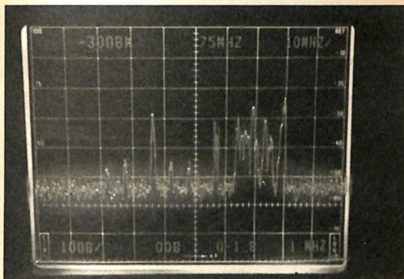
*Fig. 10.-Immagini ottenute sullo schermo di un analizzatore di spettro, corrispondenti alla banda FM completa, nella quale si possono osservare le portanti delle differenti emittenti, e un canale televisivo con le sue due bande: video e audio.*
