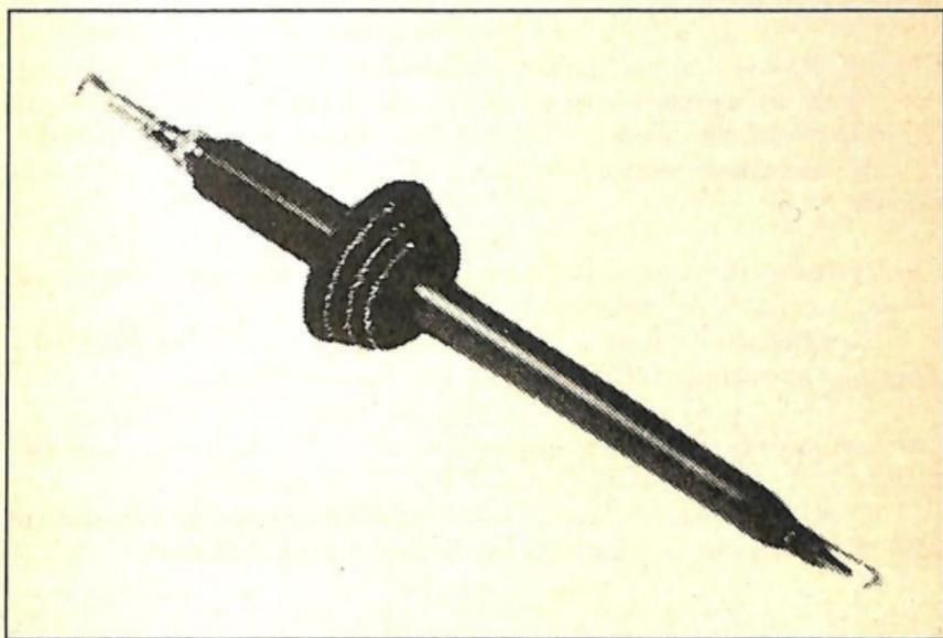
*Fig. 12.-Sonda per alta tensione. Molto utilizzata per la misura E.A.T. dei ricevitori TV.*
