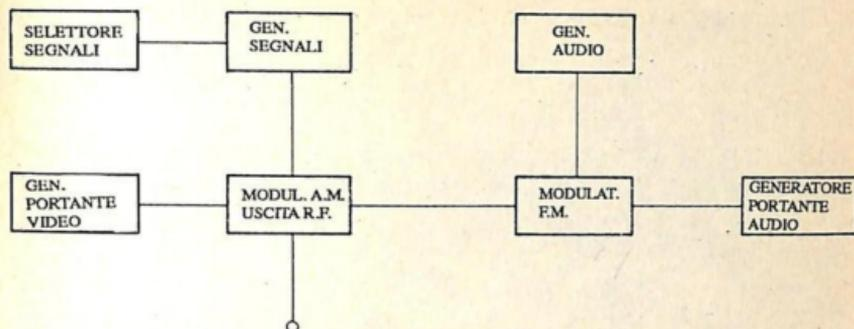
Fig. 7.-Schema a blocchi di base di un generatore video.
