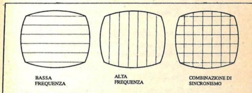
Fig. 2.-Immagini ottenute con segnali video ad onda quadra.
