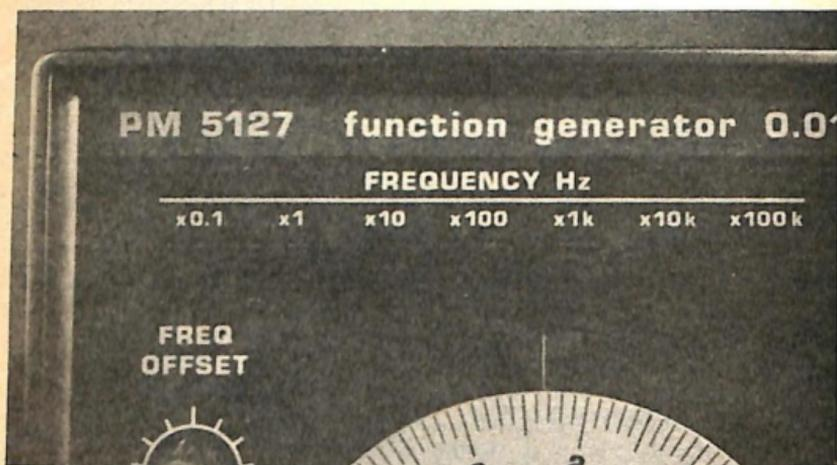
*Fig. 5.-Selettore della banda di frequenza in uscita. Il valore indicato dal pulsante si moltiplicherà per quello indicato dalla manopola di controllo.*
