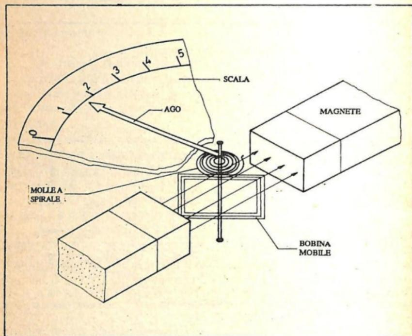
Fig. 6.-Galvanometro a bobina mobile.
