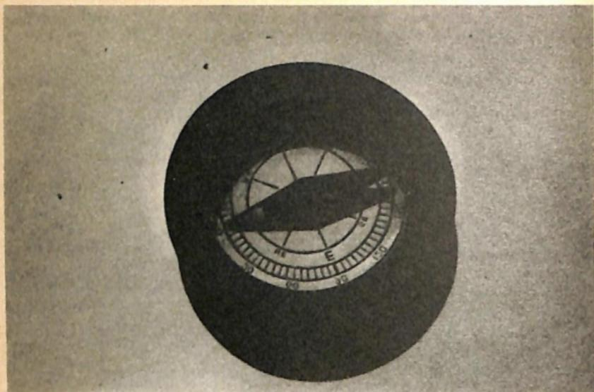
Fig. 3.-L'ago di una bussola si orienta in funzione del campo magnetico prodotto dalla terra.
