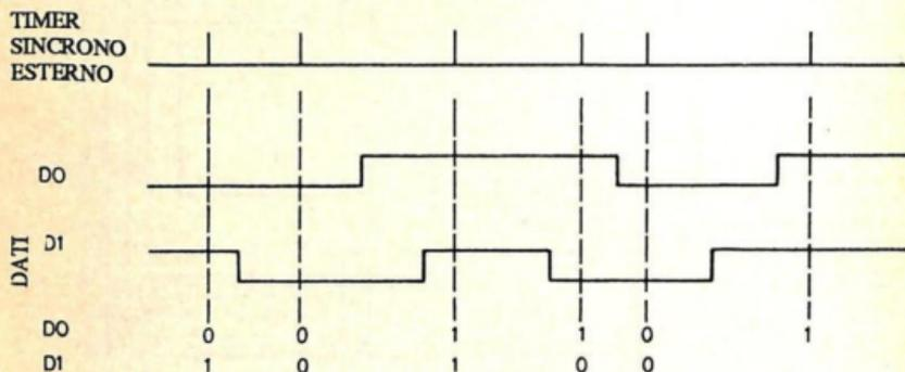
Fig. 18.-Sistema di acquisizione dati sincrono.
