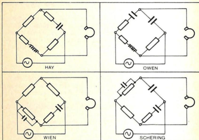
Fig. 4.-Diversi tipi di ponti a impedenza, nei quali i rami possono essere formati da elementi quali condensatori, bobine e resistenze.
