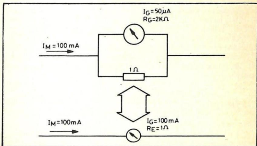
Fig. 9.-Funzionamento della resistenza di shunt, e calcolo della stessa.
