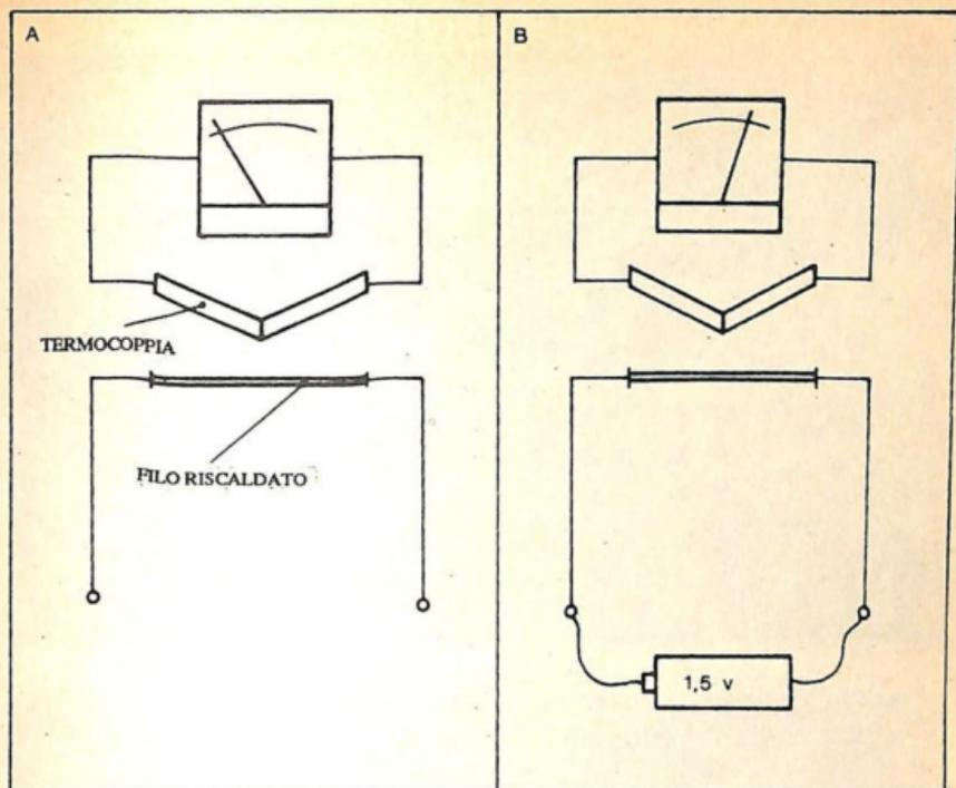
Fig. 16.-Principio di funzionamento di uno strumento che utilizza una termocoppia.
