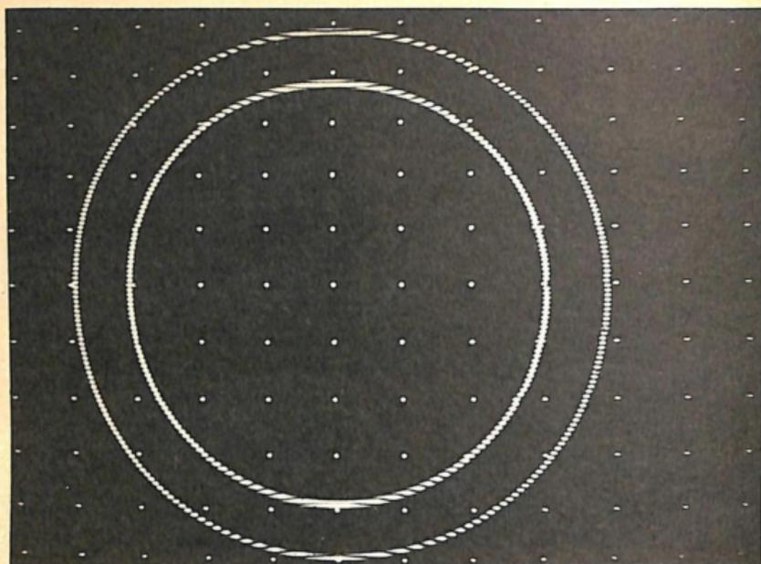
Fig. 9.-Segnale a cerchio per la regolazione della geometria.
