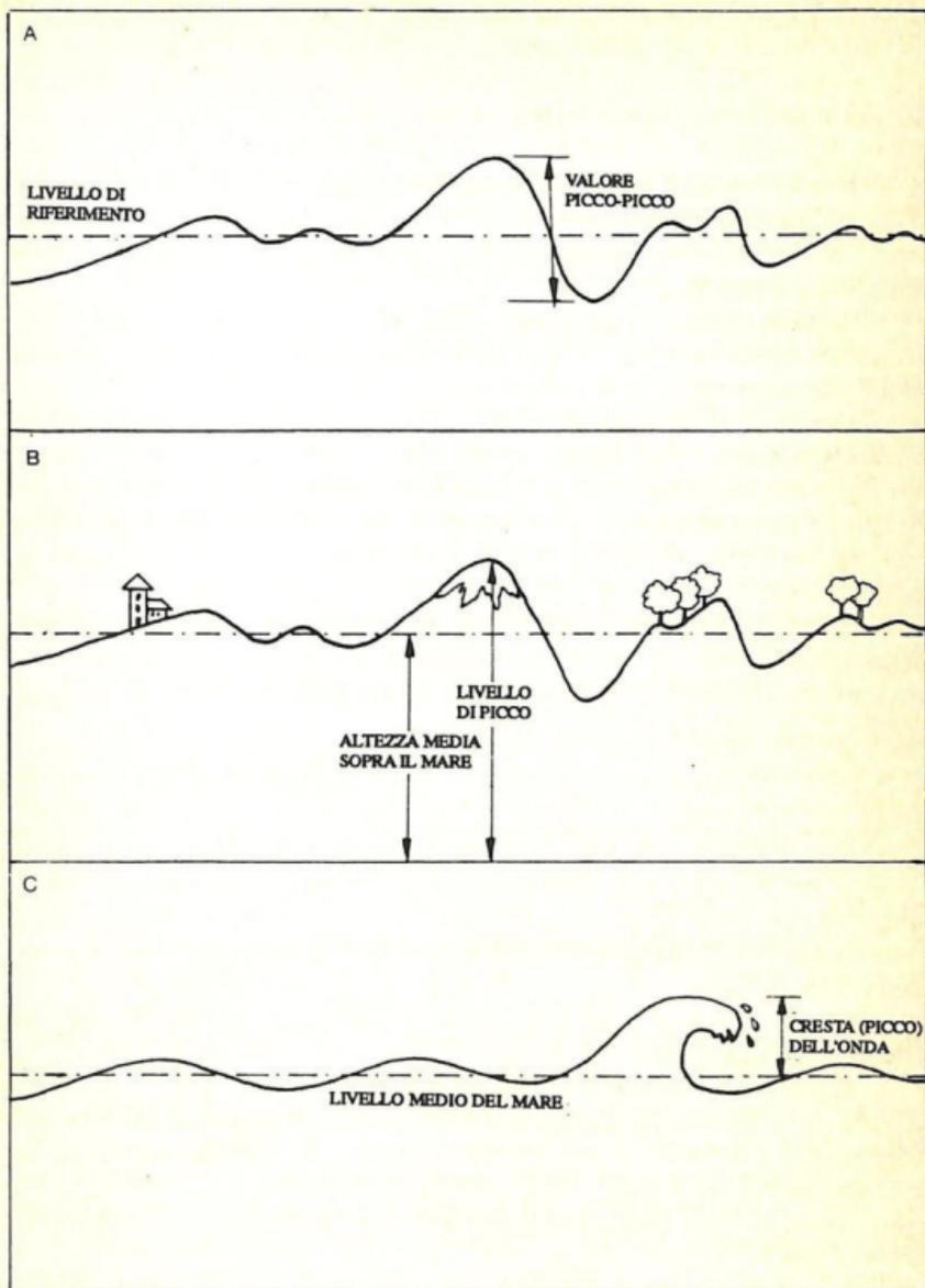
Fig. 7. - Le forze d'onda variabili hanno una grossa somiglianza con i profili del terreno, o con il profilo verticale della superficie del mare.
