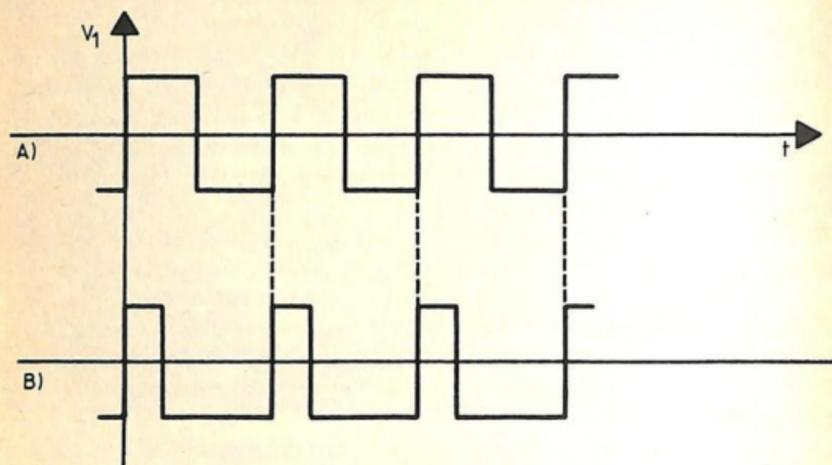
Fig. 3.-Due differenti cicli utili (duty-cycle), in un'onda quadra. a) Quando la permanenza ai due livelli è simile, si ha il 50%. b) In questo caso la durata del livello alto è la quarta parte del periodo totale, corrispondendo a circa il 25%.
