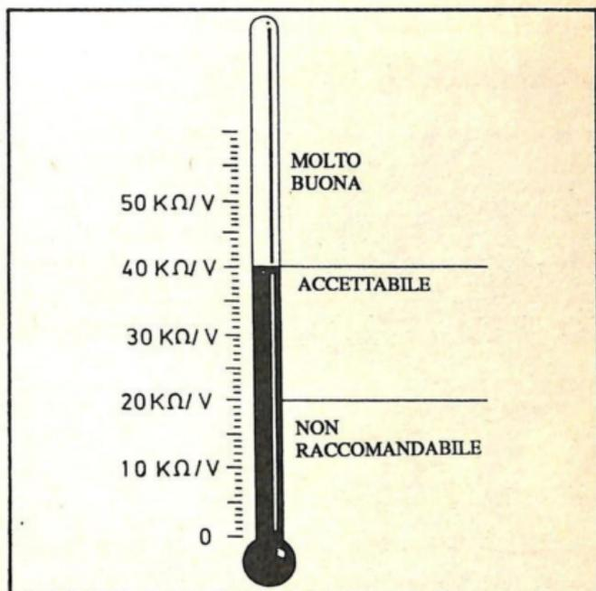
Fig. 4.-Scala per la scelta della sensibilità del tester.
