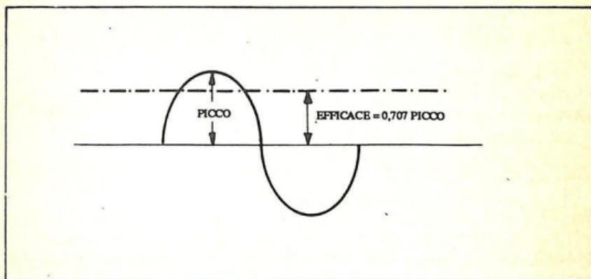
Fig. 9.-I valori di picco e efficaci per un'onda sinusoidale (o una determinata qualsiasi) sono relazionati da fattori di valore costante (in questo caso, 0,707).
