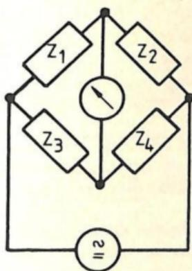
Fig. 1.-Ponte a impedenze.
