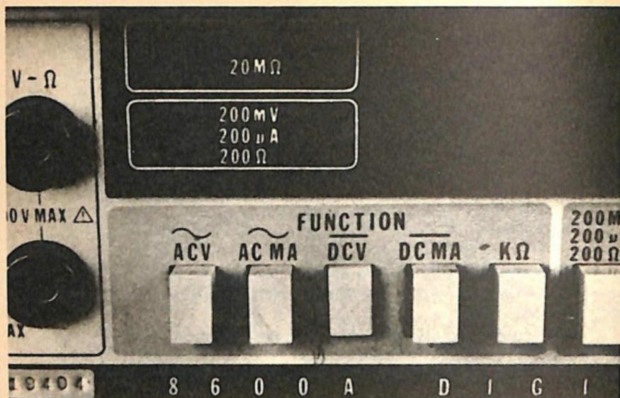
Fig. 5.-Funzioni di cui dispone un tester digitale. Possono osservarsi sul display i due riquadri che segnaleranno in modo luminoso il sovraccarico della scala. Il foro sulla destra è destinato alla regolazione dello zero.
