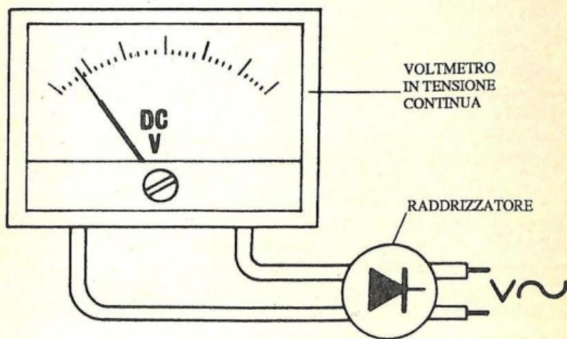
Fig. 5.-Voltmetro a bobina mobile e corrente continua, convertito in alternata con l'aggiunta di un raddrizzatore.
