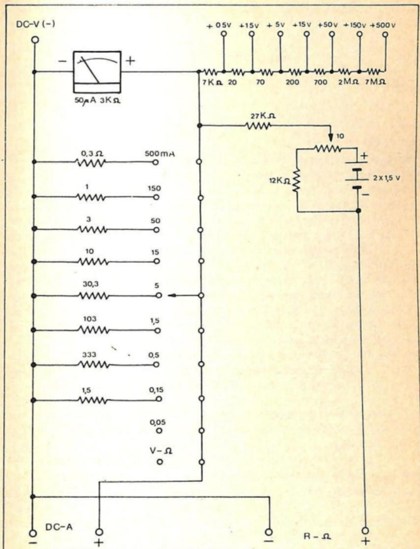
Fig. 3.-Schema teorico del tester sperimentale commentato nel testo.
