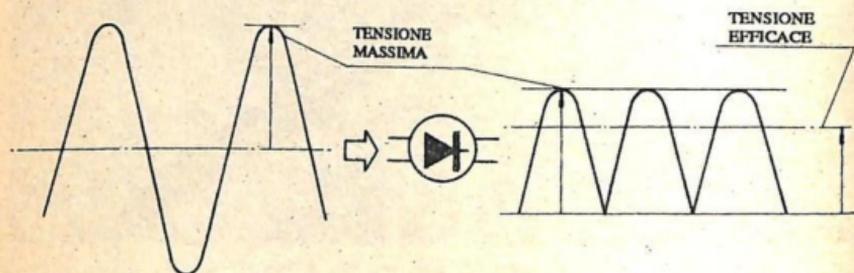
Fig. 11.-Tensione ottenuta dopo un raddrizzatore. Si osservi la differenza tra la tensione massima e quella efficace.
