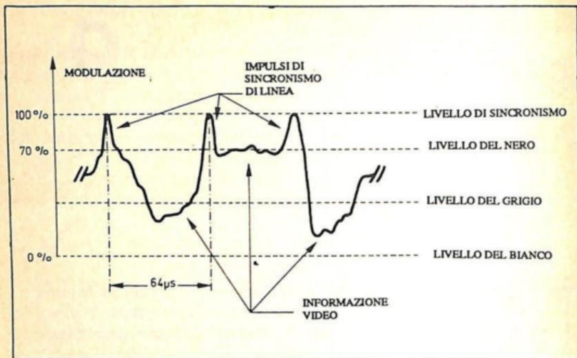
Fig. 1.-Forma del segnale TV. Due linee successive sono separate dagli impulsi di sincronismo.
