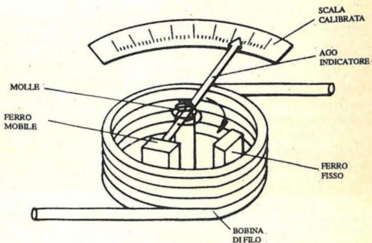
Fig. 6.-Principio di funzionamento del sistema a ferro mobile.
