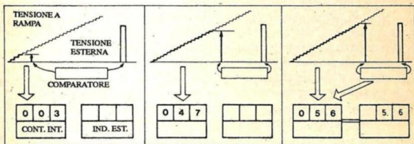
Fig. 9.-Funzionamento schematico di un tester digitale. Quello qui mostrato non è l'unico principio impiegato.
