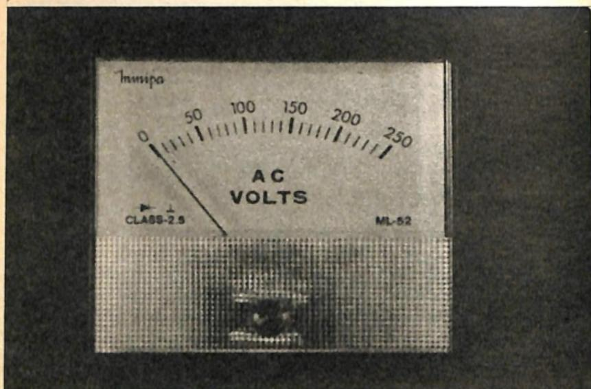
*Fig. 6.-Voltmetro a bobina mobile con il rettificatore incorporato, che consente di realizzare misure in tensione alternata. Scala da 0 a 250 V. Scatola grande.*
