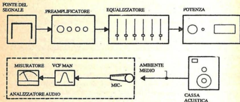
Fig. 15.-Schema di principio di una misura di risposta acustica.
