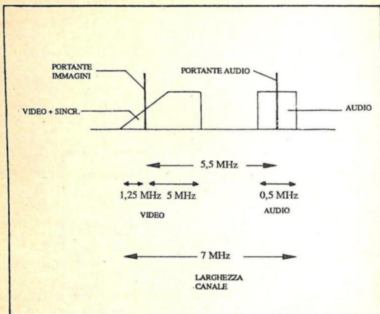
Fig. 4.-Larghezza di banda di un segnale TV modulato.
