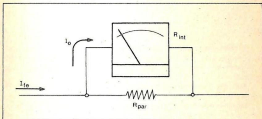
Fig. 1.-Sotto, schema equivalente e simboli utilizzati per il misuratore di intensità di corrente. Sopra, schema equivalente e simboli utilizzati per il misuratore di tensioni elettriche.
