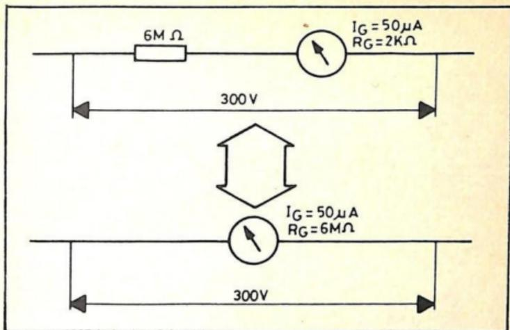
Fig. 2.-Calcolo della resistenza serie di un voltmetro.
