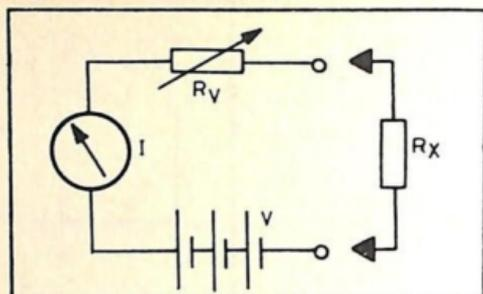
Fig. 3.-Sistema per misure di resistenza, con una regolabile in serie a quella non nota.
