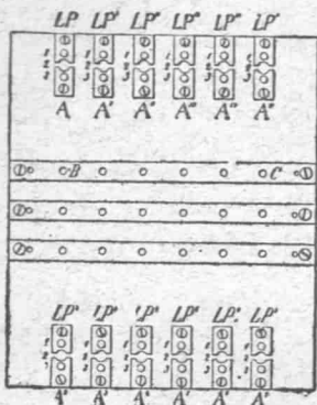
Fig. 65. — Commutatore a 12 blocchetti tipo N. 1 per linee o pile.
