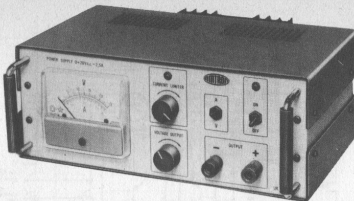
Figura 35. L'alimentatore montato. L'estetica è piacevolmente professionale, la robustezza notevole.
