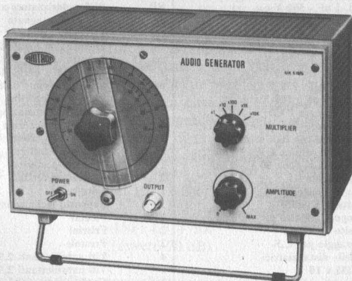
Figura 88. Il generatore montato e pronto all'uso.
