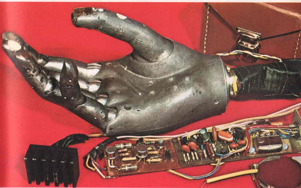
Una protesi elettronica in grado di svolgere quasi tutte le funzioni di una mano: essa può afferrare oggetti in base a un comando del cervello e può trasmettere a questo delle sensazioni tattili e termiche tramite alcuni sensori incorporati nelle dita artificiali.
