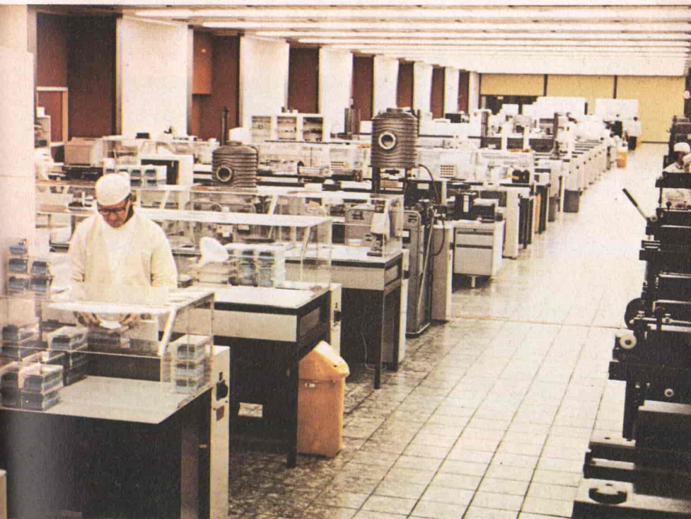
Interno di uno stabilimento in cui si producono circuiti integrati. Poiché un solo granello di polvere può rovinare un circuito, l'aria dei locali viene depurata fino a diventare cento volte meno polverosa di quella atmosferica.
