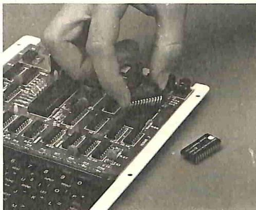
Fig. 3.3. La sostituzione della ROM
