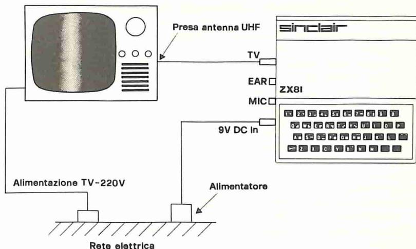
Fig. 3.5. Schema di collegamento per lo ZX81
