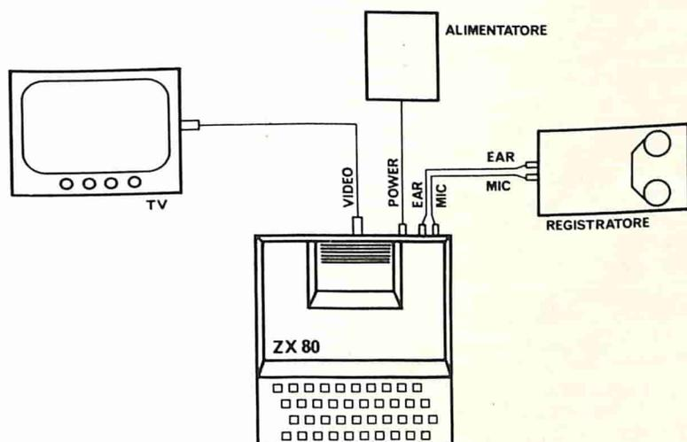
Fig. 3.1. Schema di collegamento per lo ZX80
