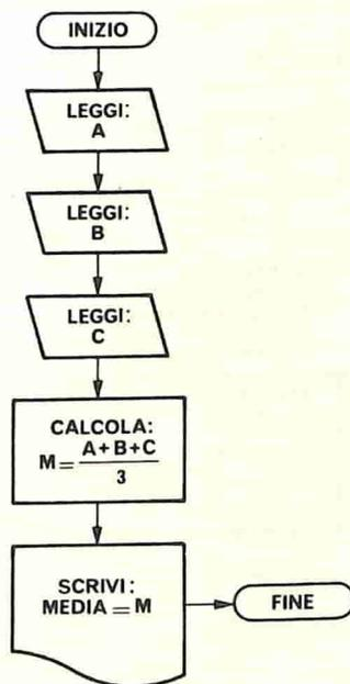
Fig. 4.2. Diagramma a blocchi media 3 numeri
