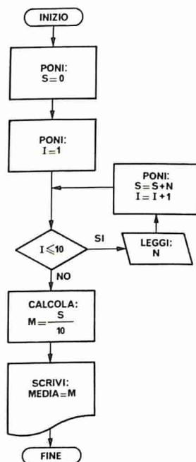
Fig. 4.3. Diagramma a blocchi media 10 numeri
