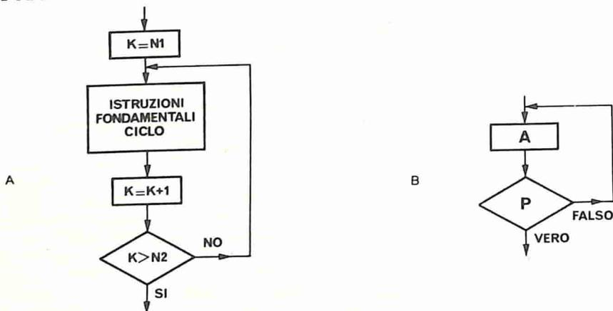
Il concetto di operazione ciclica e' fondamentale nella programmazione, si fa pero' notare che se non fosse disponibile la coppia di istruzioni FOR/NEXT si potrebbe ottenere lo stesso risultato gestendo a programma un contatore di ciclo ed usando la istruzione IF/THEN.
