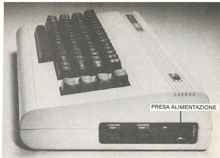
**Figura 1.2 – Collegamento elettrico al computer.**
