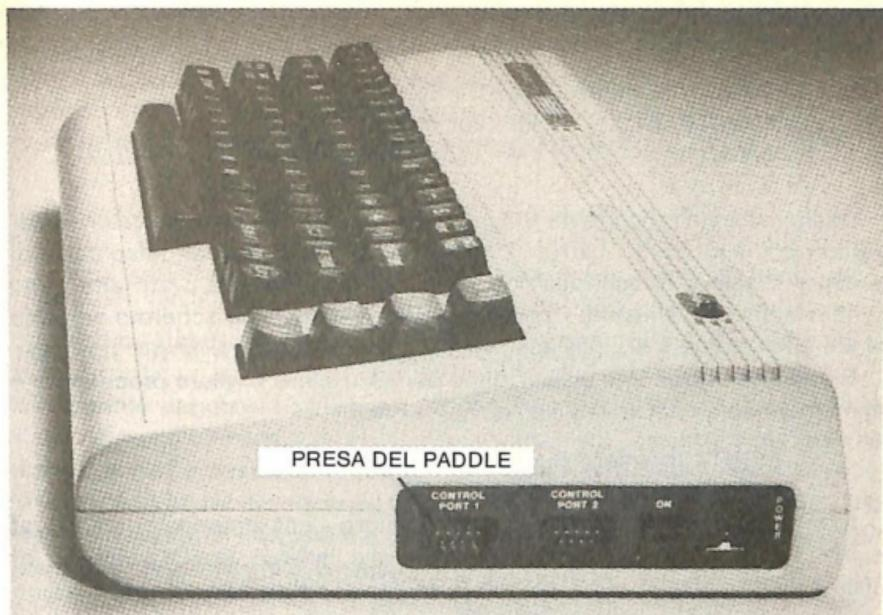
**Figura 6.8 – CONTROL PORT 1, la presa per il paddle.**
