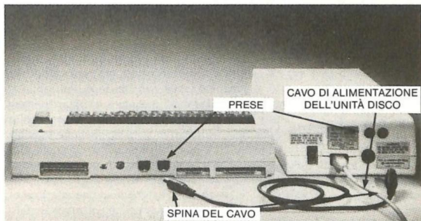
Figura 8.2 — Collegamento tra calcolatore e unità-disco: prese, cavo di alimentazione dell'unità-disco, spina.
