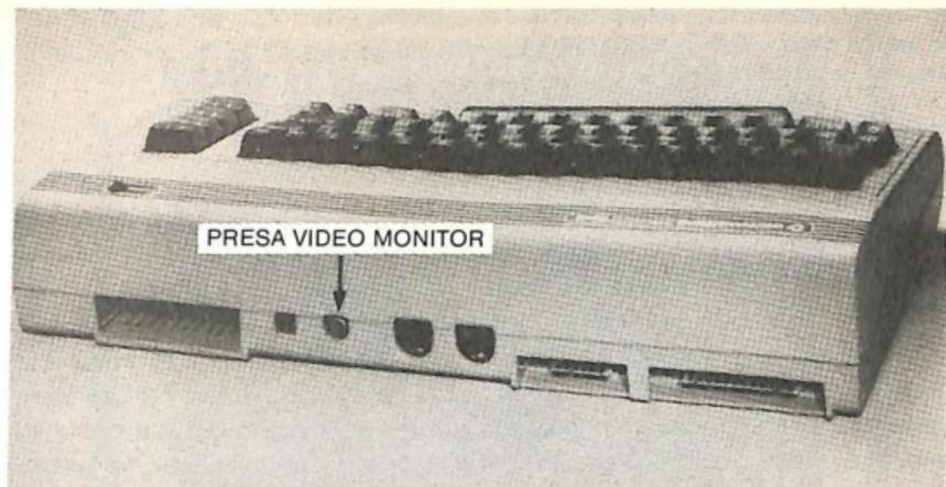
Figura 1.4 – La presa per il monitor.
