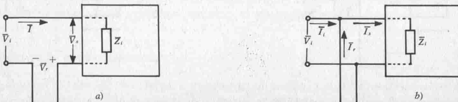
Fig. 9. - Circuito d'ingresso di un amplificatore a reazione: a) tipo serie; b) tipo parallelo.
