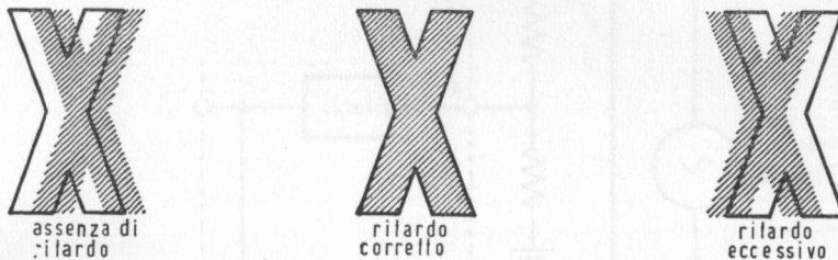
FIG. 121. Necessità della presenza di una linea di ritardo sui segnali di luminanza per farli coincidere sullo schermo d'immagine con quelli di crominanza.
