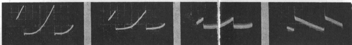
5. Terminale B. 8 V - p.p. 6. Terminale 6. 6 V - p.p. 7. Terminale H. 4 V - p.p. 8. Terminale C. 10 V - p.p. Onda di tensione di entrata verticale. Onda di tensione verticale verde. Onda di tensione verticale rosso. Deformazione verticale positiva.
