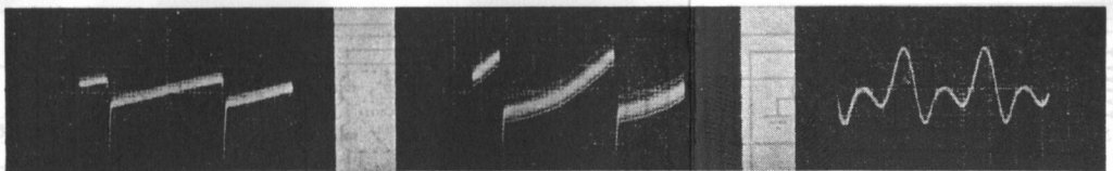
9. Terminale D. 8 V - p.p. Deformazione verticale negativa. 10. Terminale F. 10V-p.p. Onda di tensione verticale verde. 11. Terminale A, B, C. 15 V - p.p. Tensione ai capi della bobina "orizzontale blu" L 803 .
