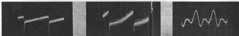
9. Terminale D. 8 V - p.p. Deformazione verticale negativa. 10. Terminale F. 10V - p.p. Onda di tensione verticale verde. 11. Terminale A, B, C. 15 V - p.p. Tensione ai capi della bobina "orizzontale blu" 1-803.
