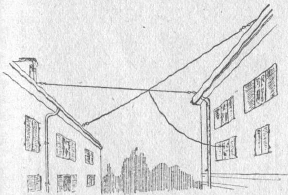
Fig 6-a - Aereo bifilare incrociato.
