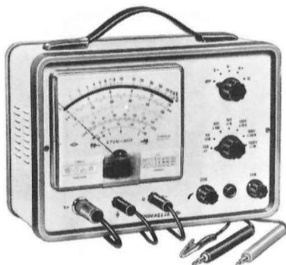
in Volt PP - Ohmmetro elettronico - Campo di misure da 0,2 ohm a 1000 M $\Omega$  valore di centro scala 10 - Alimentazione con pila da 1,5 V - Strumento a bobina mobile e magnete permanente - Sensibilità 200  $\mu$ A 500 ohm cc Classe, 1,5 - Flangia gran luce in metacrilato - Quadrante a specchio con 5 scale a 3 colori - Vite esterna per la regolazione dell'indice. Accessori a richiesta: puntale AT 1001 per misure fino a 30 KV cc - Sonda RF 1001 con campo nominale di frequenza fino a 250 MHz.
