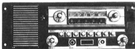
L'apparato consta di un telaio di supporto con amplificatore di BF incorporato, da fissarsi nella carrozzeria, nel quale può essere inserito a « coulisse » il complesso sintonizzatore.
