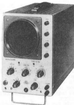
Tubo impiegato: D13-480 GH o equivalente - reticolo graduato  $6 \times 10$  cm - potenziale EAT - 1300 V stabilizzati.
