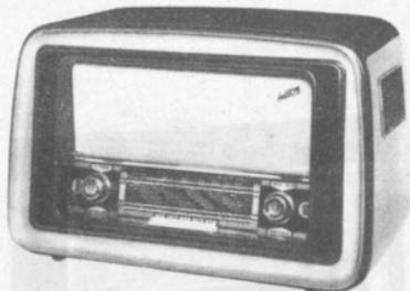
Potenza d'uscita: 3 W a 400 Hz col 10 % di distorsione - 1,5 W a 1.000 Hz col 1 % di distorsione - 0,5 W a 1.000 Hz con lo 0,8 % di distorsione.
