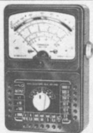
Batterie impiegate: n. 2 da 1,5 V per portate basse - n. 1 da 30 V per portate 100 Mohm.
