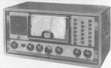
Frequenza intermedia del ricevitore: M. d.A.: 67 kHz; M.d.F.: 10,7 MHz.
