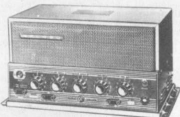
Controlli: volume micro 1 - volume fono - selettore d'ingresso - controllo note alte - controllo note basse.
