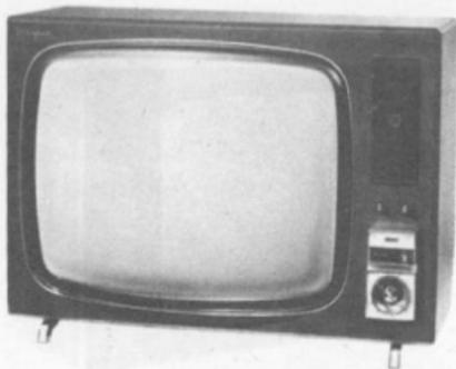
Amplificatore - Convertitore UHF a transistors - Sintonia fine UHF elettronica - Commutatore VHF-UHF a pulsante - Stabilizzazioni delle deflessioni - Spegnimento dei ritorni orizzontali e verticali - Indicatore del programma con lampade al neon.
