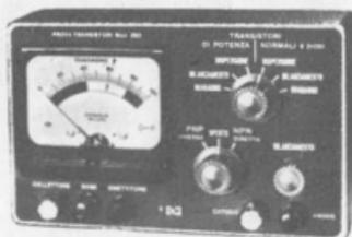
**Provatransistori mod. 650 portatile**
