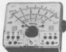
Con dispositivo di protezione contro sovraccarichi per errate inserzioni.
