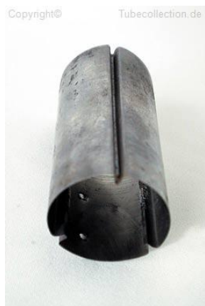
Schermo magnetico per URDOX a biossido di uranio, ferro e idrogeno UE (=U+EW)
