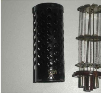
Marelli RD114 Resistenza di caduta Plug-in per rete AC/DC a 125/160V
