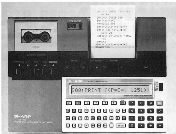
Figura 1. Il compattissimo PC-1251 della Sharp, un pocket in Basic che racchiude in sé molte potenti funzioni. È realmente ciò che presagivano lo scorso novembre sul fascicolo speciale di BIT: il Basic credit-card. Inoltre permette di tenere in borsa anche il completo stampante-registratore a microcassette, veramente un'ottima soluzione per rendere velocemente utilizzabili i pocket, altrimenti sottoimpiegati.
