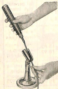
Come si mette il mi- crofono a stilo M 62/ A - M 63 nel suo so- stegno S 95
