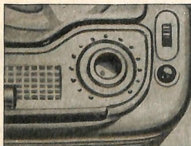
Particolare del controllo di tono (manopola più grande, coassiale col comando di volume).
