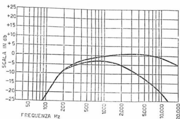
Curva di risposta (canale microfono) ed effetto della regolazione del controllo di tono.
