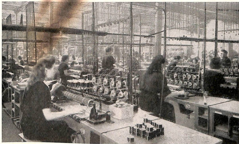
Vista del reparto macchine avvolgitrici per trasformatori e bobine (1939).
