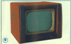
9. Graetz Fernsehgerät F6 19+1 Germanium-Diode. Valvole n° 16.
