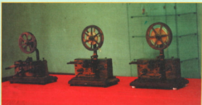
(A lato) Campione di cavo coassiale per la dorsale interurbana nazionale. (In alto) Alcuni tipi di ricevitori telegrafici italiani sistema "Hip".
