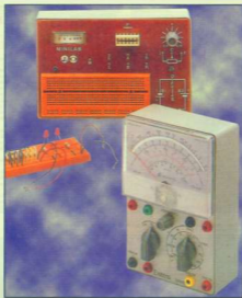
IL MINILAB E LA BASE SULLA QUALE GLI ALLIEVI POSSONO SPERIMENTARE CIRCUITI E APPRENDERE LE CONOSCENZE PIÙ IMPORTANTI DI ELETTRONICA. OGNUNO POTRÀ MONTARE IL MINILAB CON LE PROPRIE MANI ASSEMBLANDO LE PARTI STACCATTE FACENTI PARTE DELLE SERIE DI MATERIALI INVIATE AGLI ALLIEVI.
