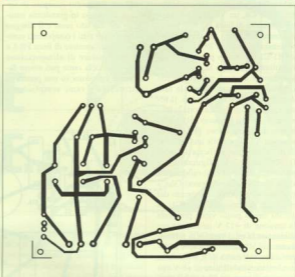
Figura 2. Traccia rame del circuito stampato vista dal lato rame in dimensioni naturali.
