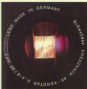
Figura 5. Corretta centratura della lampada rispetto all'obiettivo.
