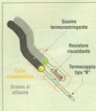
Figura 2. Particolare della sonda di rilevazione della temperatura.
