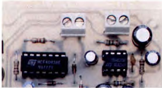
Figura 3. Disposizione dei componenti sulla bassetta stampata.
