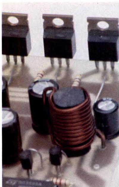
fino a leggere circa 38 V per ramo. Consigliamo perciò di porre su una delle uscite un multimetro predisposto alla misura di tensioni continue con fondo scala di 100 V. Il diodo LED deve illuminarsi. Per eseguire bene la regolazione consigliamo di collegare alle uscite due resistori da 47  $\Omega$  - 21 W. Comunque in linea di massima il cursore del trimmer deve stare a tre quarti di corsa verso il trasformatore come visibile nelle foto.
