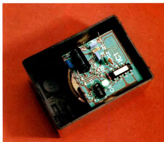
finitivo va ovviamente eseguito attivando un telefonino e avvicinando o appoggiando la capsula del CLIPPO all'altoparlantino interno: tutto quanto ricevuto sarà udibile anche a parecchi metri di di-
