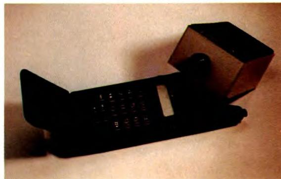
**Rilevazione microfonica.** Una piccola capsula sporgente di appena 2-3 mm sul retro del box del Clippo effettua la rilevazione diretta di quanto riceve il cellulare durante un colloquio telefonico. La capsula va avvicinata o, meglio, appoggiata a contatto dei forellini (genericamente presenti sopra il display) che nascondono il microscopico altoparlante interno.
