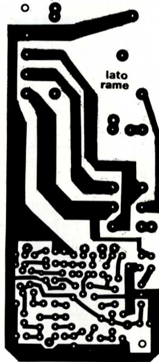
Figura 2. Piste di rame del circuito stampato in scala unitaria.
