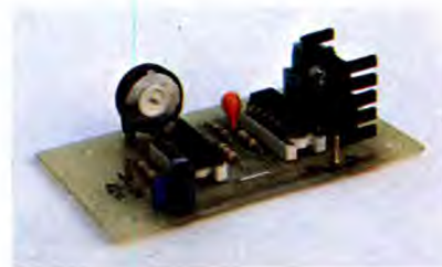
Figura 4. Disposizione dei resistori e dei LED sul lato componenti.
