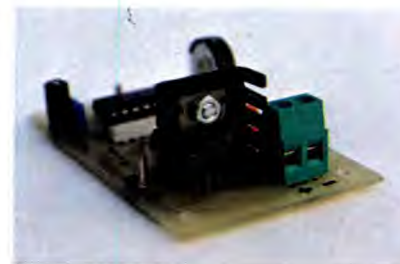
Figura 5. Alcuni componenti vanno montati dal lato rame.
