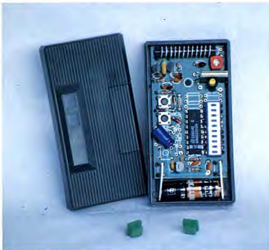
Figura 3. A causa delle dimensioni ridotte della basetta, parecchi componenti vanno montati in verticale.
