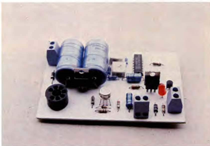
Figura 3. Disposizione dei componenti. Montare il sensore usando l'apposito zoccolo.
