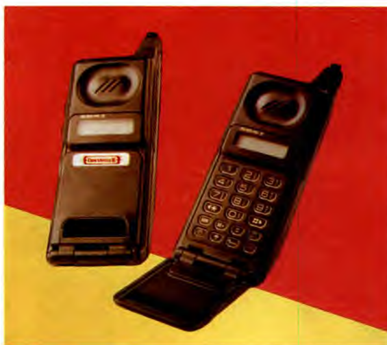
Foto 1. Radiotelefono. La rete nazionale SIP è attualmente a doppia struttura: tradizionale a filo, oppure con agganciamento via etere in alta frequenza, possibile abilitando alla comunicazione appositi dispositivi elettronici rice-trasmittenti continuamente assistiti da un sistema di stazioni radio interconnesse.
