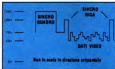
Figura 3. Rappresentazione schematica del segnale al catodo.
