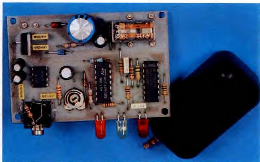
L'aumento del numero di furti, truffe, intrusioni indebite obbliga ogni giorno a proteggerci in modo efficace. Digikey, serratura elettronica codificata in frequenza, di concezione modulare e di dimensioni molto ridotte, può essere installata in un qualunque sistema preesistente, per permettervi o meno l'accesso.
