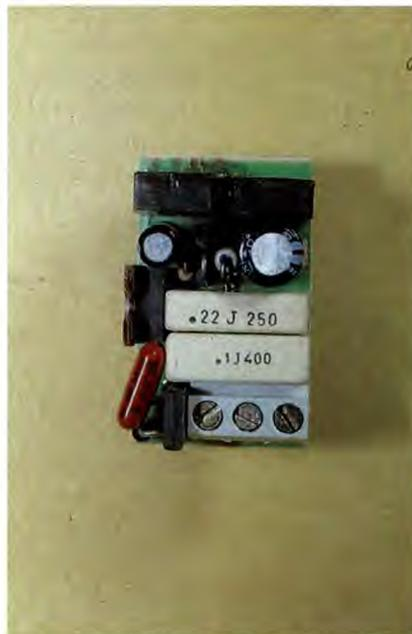
rete elettrica è connessa direttamente al negativo del circuito. Consigliamo quindi di scollegare l'alimentazione prima di effettuare qualsiasi operazione, avendo anche la accortezza di fare scaricare i condensatori C'4 e C'5. Per fare ciò si possono mettere in corto i loro terminali con una punta di cacciavite (ovviamente dopo aver tolto l'alimentazione), oppure si può lasciare sconnesso il
