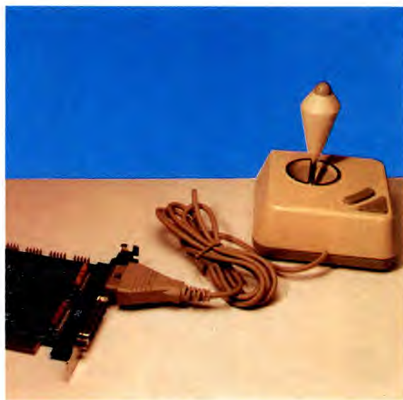
Joystick. Un connettore tipo DB-15 (8+7 poli) consente il rapido collegamento alle schede game di qualsiasi joystick PC-compatibile.
