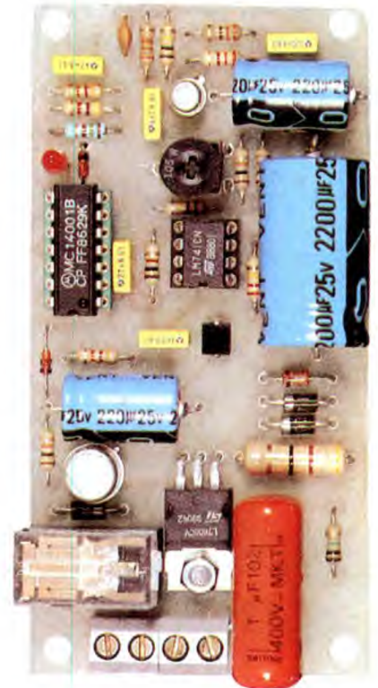
Figura 4. Circuito elettrico del ricevitore. Per offrire assoluta sicurezza, la tensione di alimentazione viene stabilizzata da un regolatore di tensione integrato.
