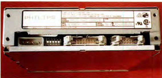
8a. Memoria a raggio laser. Il CD-ROM (8a) è attualmente il dispositivo di lettura ottica più diffuso; esternamente è molto simile a un floppy drive 5,25" (8b) e presenta sul retro la doppia connessione all'alimentazione e al bus di comunicazione (8c).
