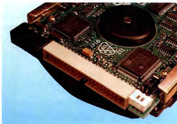
Collegamenti dell'hard disk drive. Ogni hard disk drive prevede sempre doppia connessione: una alla linea di alimentazione e l'altra al bus di comunicazione con l'interfaccia di controllo (7).
