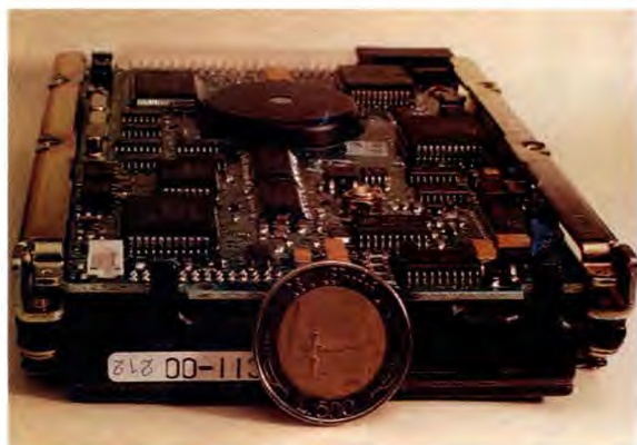
6. Serie Slim. La cosiddetta hard disk serie slim comprende nuovi apparecchi potenti, veloci, e di spessore inferiore al diametro di una moneta di 500 lire (6).
